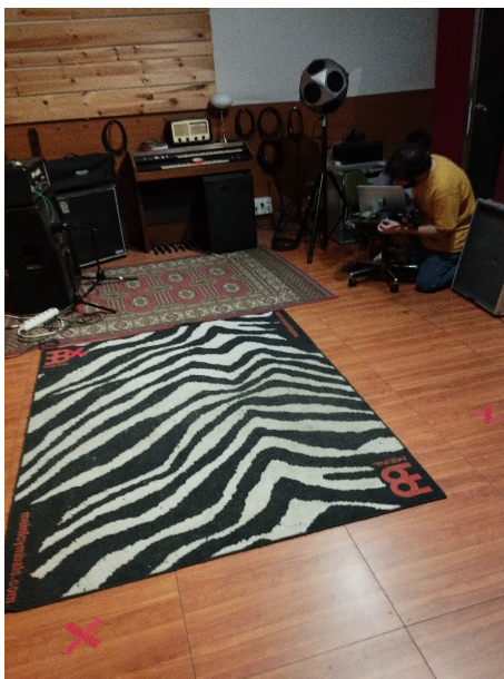
Figura 29 Fuente situada en una de las dos posiciones (PF1) y las tres posiciones de micro para esa posición de fuente. Las posiciones de receptor están marcadas con cruces rojas en el suelo.
