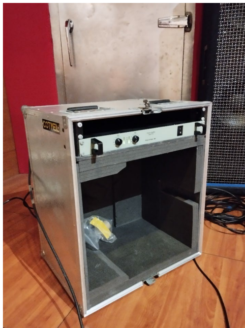
Figura 32 Detalle del amplificador de audio empleado modelo 2716C marca Brüel & Kjær.
