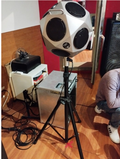
Figura 31 Fuente dodecaédrica. omnidireccional situada en la posición de fuente 1. En el rack plateado puede verse el amplificador de audio empleado.
