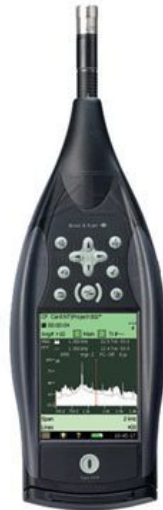
Figura 28 Imagen del sonómetro .Brüel & Kjær, 2270, con el micrófono incorporado en el mismo [6].
