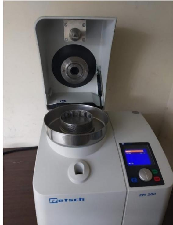
Figura 3. Trituradora tipo "Cutter"
