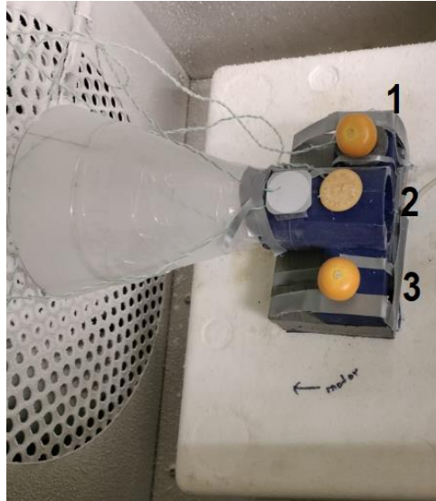
Figura 8. Posicionamiento de los aguaymantos. (1) Medición de temperatura superficial y den centro de la muestra. (2) Medida de la temperatura superficial mediante cámara infrarroja. (3) Medidas dieléctricas.
