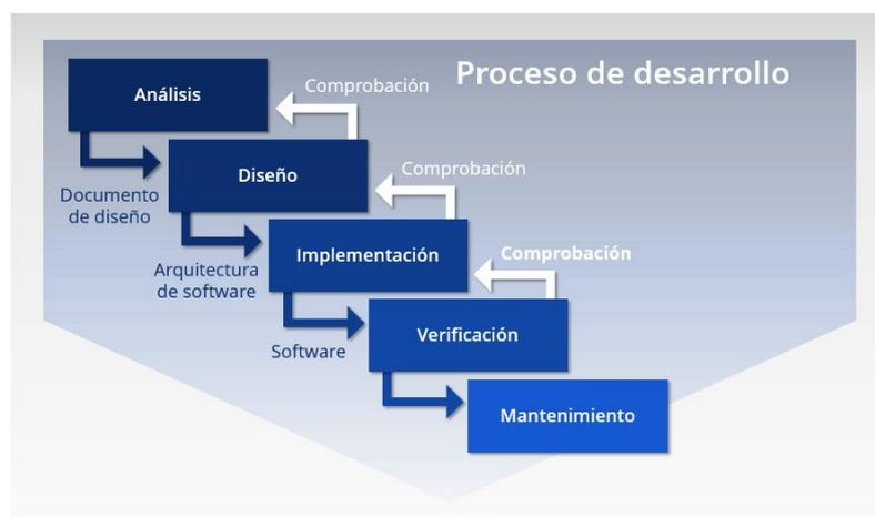
Figura 3.1: Diagrama del enfoque tradicional o en cascada
