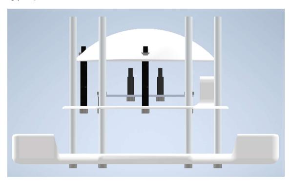
Fase 8: Se introducen, en el elemento 2 (Marco), ocho elementos 6 (Tornillo M3x20) en los agujeros interiores respecto huecos rectangulares. Los cuatro elementos 1 (Ala) se posicionan en cada uno de estos grupos y se fijan mediante el roscado de elementos 12. Las cabezas de los elementos 6 han de quedar en la parte en que el diámetro de los agujeros cónicos sea menor.
