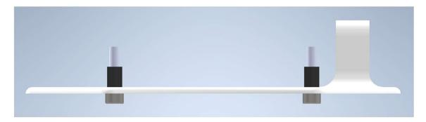
Fase 2: Se introducen, en los agujeros centrales del elemento 21 (PCB), dos elementos 19 que se atornillan a los elementos 22 (Pilar mediano).
