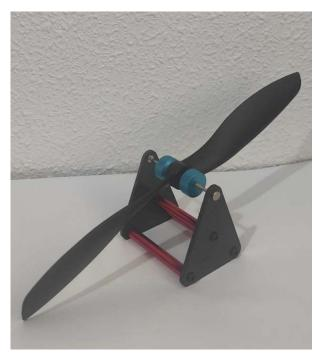
Nota. Fuente propia. Hélice 8045 montada sobre equilibrador magnético.
