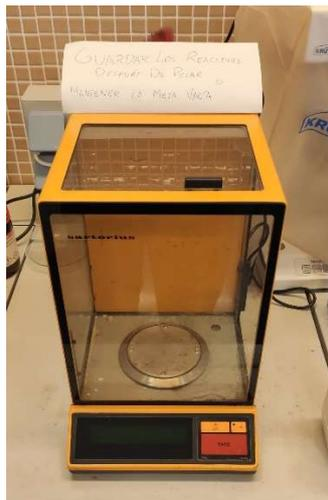
Figura 12: Balanza electrónica Sartorius
