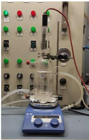
*Figura 14: Reactor cilíndrico 1L con lámpara UV*
