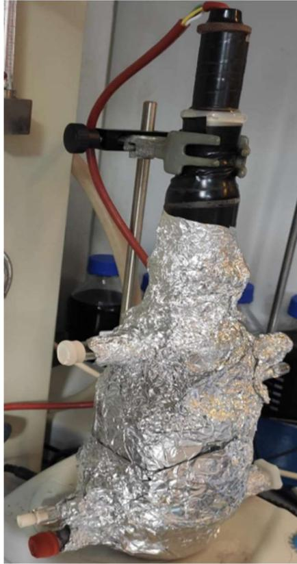
*Figura 15: Reactor cilíndrico con lámpara y protección UV*
