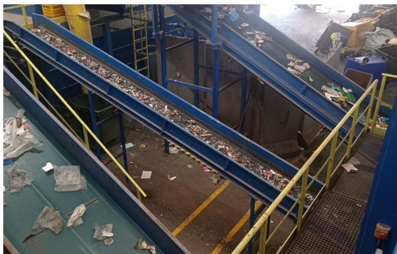
Figura 36. Resultado de la separación de los materiales por vibración
