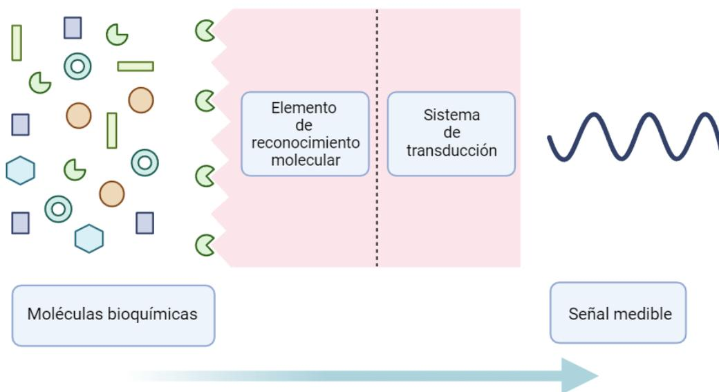
Figura 2.3: Esquema de los elementos básicos de un biosensor (Martín Sánchez, 2019a)
