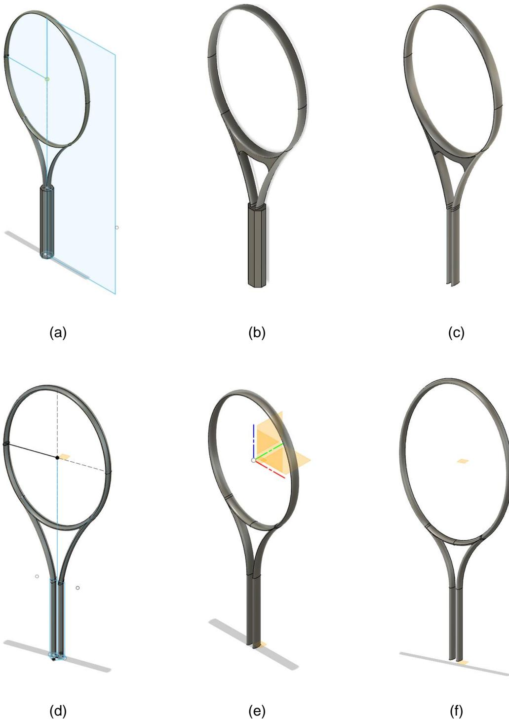
*Tabla 3. Prototipos de modelos de marcos de raquetas de tenis realizados en este trabajo. (a) Modelo con empuñadura sólida; (b) Modelo con empuñadura sólida y refuerzo redondeado; (c) Modelo con refuerzo redondeado; (d) Modelo con garganta semi redondeada; (e) Modelo con superficie de golpeo reducida; (f) Modelo límite con garganta angosta.*
