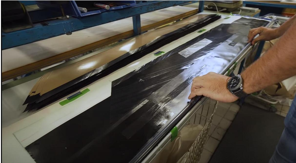
*Figura 8. Creación de laminado por enrollamiento de las láminas preimpregnadas.*
