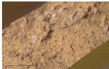
Figura 69. Detall a x10 de la secció transversal de la proveta M1-OL-50ARB. Font: Fotografia de l'autora.
