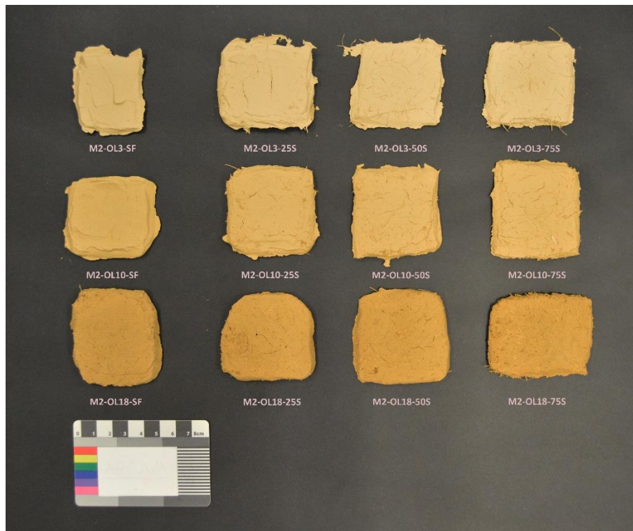
Figura 132. Conjunt de provetes de morter amb oli d'oliva amb fibres de corda de sisal. Font: Fotografia de l'autora.
