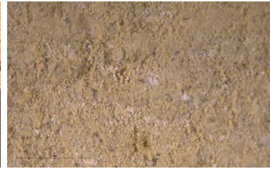
Figura 61. Detall a x10 de la superfície de la proveta de morter de terra al 3% d'oli d'oliva usada durant la campanya de l'any 2022 a Sant Jaume. Font: Fotografia de l'autora.
