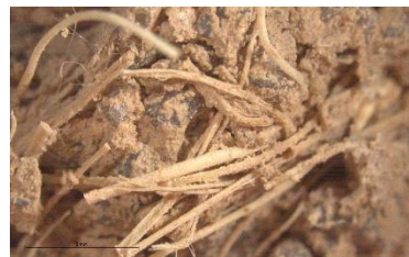
Figura 130. Detall a x10 de la secció transversal de la proveta M1-LLI-AR-S. Font: Fotografia de l'autora.
