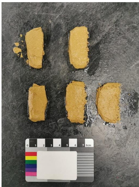
Figura 186. Resultat de les provetes que superen l'assaig. Primera fila d'esquerra a dreta: M2-LLI3-SF i M2-LLI3-50L. Segona fila d'esquerra a dreta: M2-LLI10-SF, M2-LLI10-50L i M2-LLI10-50S Font: Fotografia de l'autora.
