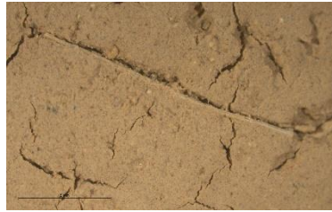
Figura 120. Detall a x10 de la superfície de la proveta M1-LLI-50S. Font: Fotografia de l'autora.
