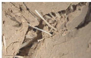
Figura 87. Detall a x10 de la secció transversal de la proveta M1-OL-50S. Font: Fotografia de l'autora.
