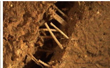
Figura 152. Detall a x10 de la secció transversal de la proveta M2-OL18-50L. Font: Fotografia de l'autora.
