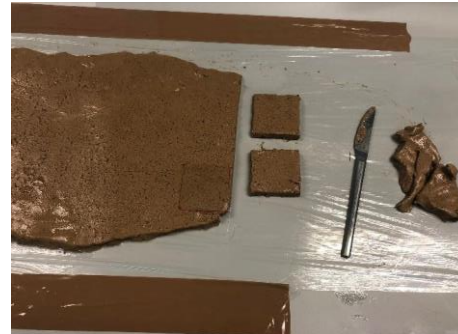
Figura 9. Procés d'elaboració de provetes: tallat en peces de 5 x 5 cm de morter amb oli d'oliva. Font: Fotografia de l'autora.
