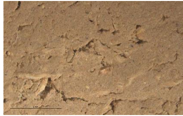
Figura 78. Detall a x10 de la superfície de la proveta M1-OL-50L. Font: Fotografia de l'autora.
