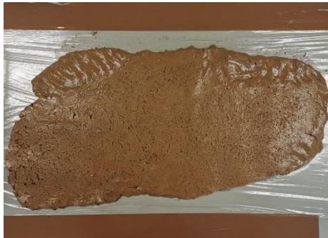
Figura 8. Procés d'elaboració de provetes: làmina de morter amb oli d'oliva. Font: Fotografia de l'autora.
