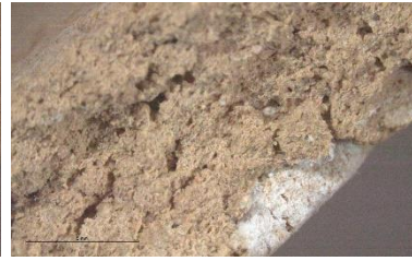
Figura 106. Detall a x10 de la secció transversal de la proveta M1-LLI-75ARB. Font: Fotografia de l'autora.
