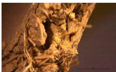
Figura 168. Detall a x10 de la secció transversal de la proveta M2-LLI3-50S. Font: Fotografia de l'autora.
