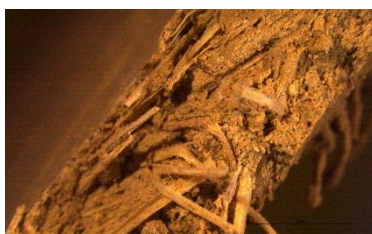
Figura 169. Detall a x10 de la secció transversal de la proveta M2-LLI10-50S. Font: Fotografia de l'autora.
