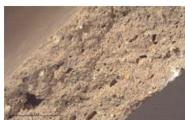
Figura 97. Detall a x10 de la secció transversal de la proveta M1-LLI-SF. Font: Fotografia de l'autora.
