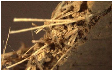
Figura 150. Detall a x10 de la secció transversal de la proveta M2-OL3-50L. Font: Fotografia de l'autora.
