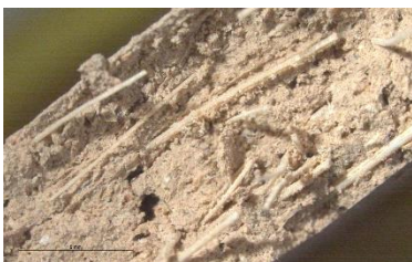
Figura 86. Detall a x10 de la secció transversal de la proveta M1-OL-25S. Font: Fotografia de l'autora.
