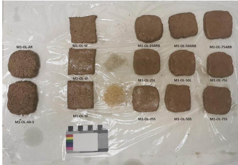
Figura 54. Provetes inicials de morter amb oli d'oliva amb fibres i àrid silici acabades de preparar. Font: Fotografia de l'autora.
