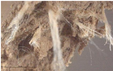
Figura 80. Detall a x10 de la secció transversal de la proveta M1-OL-25L. Font: Fotografia de l'autora.
