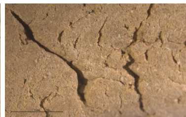
Figura 103. Detall a x10 de la superfície de la proveta M1-LLI-75ARB. Font: Fotografia de l'autora.
