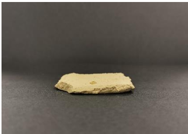
Figura 180. Gota d'aigua dipositada en M2-LLI3-SF. Font: Fotografia de l'autora.
