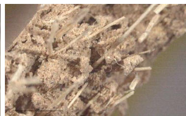
Figura 88. Detall a x10 de la secció transversal de la proveta M1-OL-75S. Font: Fotografia de l'autora.
