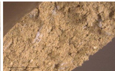
Figura 70. Detall a x10 de la secció transversal de la proveta M1-OL-75ARB. Font: Fotografia de l'autora.
