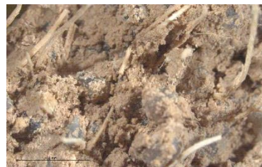
Figura 94. Detall a x10 de la secció transversal de la proveta M1-OL-AR-S. Font: Fotografia de l'autora.
