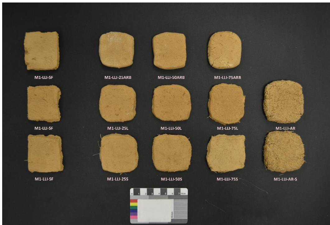
Figura 57. Conjunt de provetes inicials de morter amb oli de llinosa amb fibres i àrid silici després del procés d'assecat. Font: Fotografia de l'autora.
