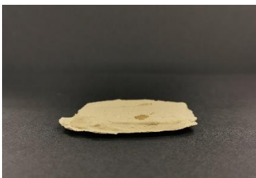
Figura 175. Gota d'aigua dipositada en M2-OL3-SF. Font: Fotografia de l'autora.
