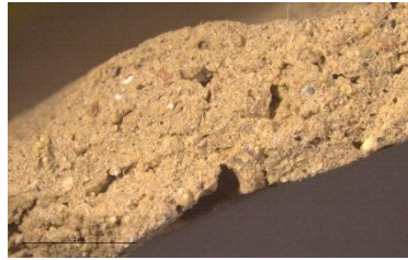
Figura 60. Detall a x10 de la secció transversal de la proveta M1-OL-SF. Font: Fotografia de l'autora.
