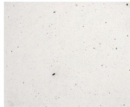
(d) sample 8 Ti64 + N2 magnification x10 before etching
