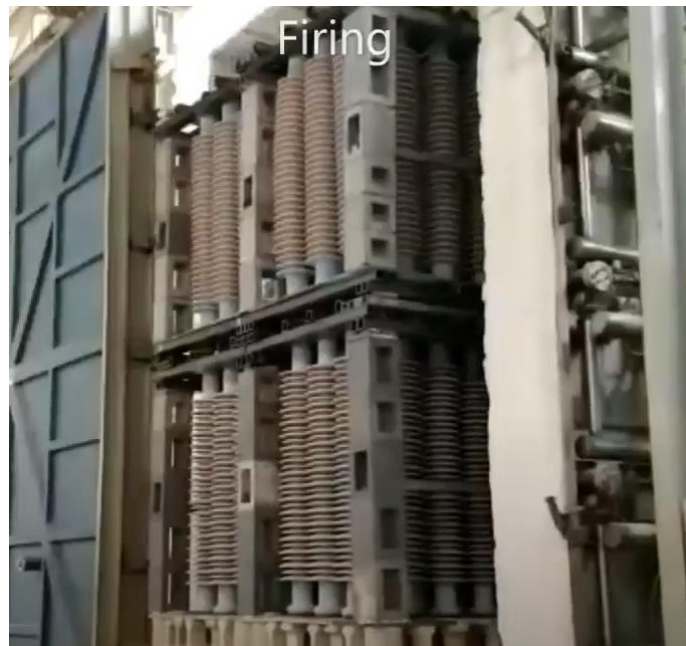
FIGURA 40: Cocción de los soportes.
