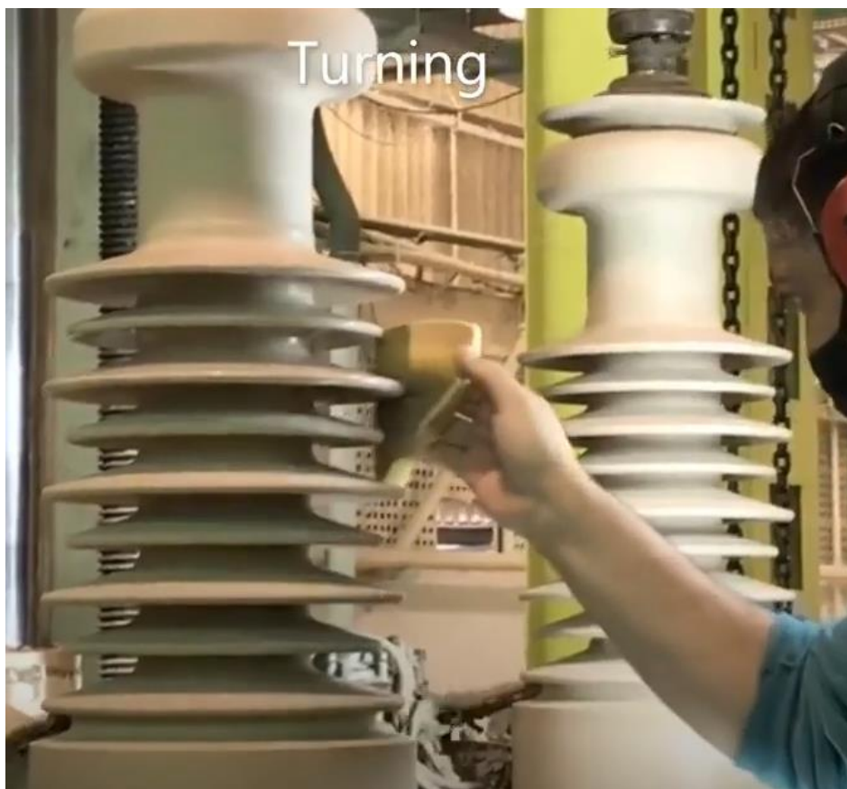
FIGURA 38: Operación de torneado de los soportes.
