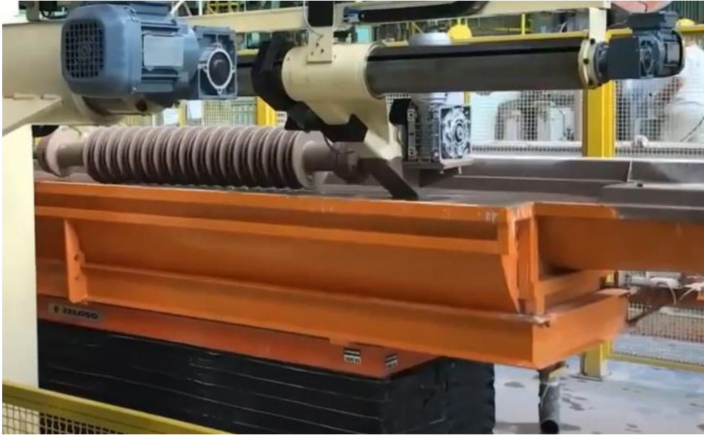
FIGURA 39: Fase de barnizado de los soportes torneados.
