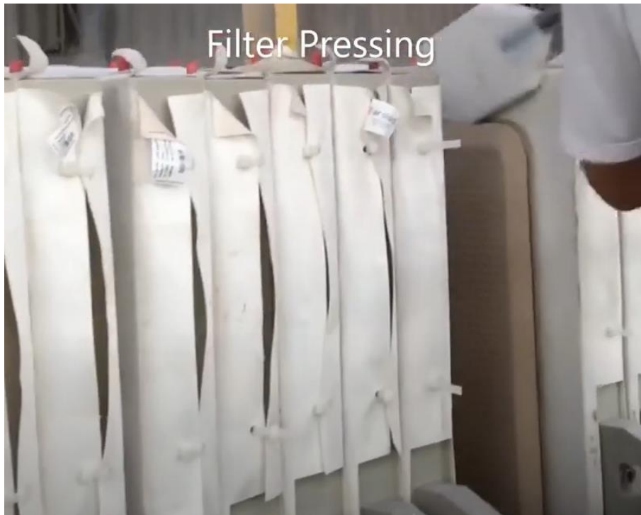
FIGURA 36: Filtro Prensa Hidráulico.
