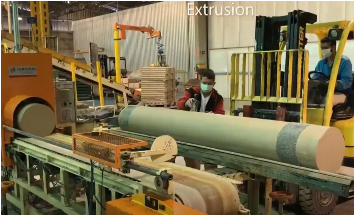
FIGURA 37: Extrusión de soportes para aisladores eléctricos porcelánicos.
