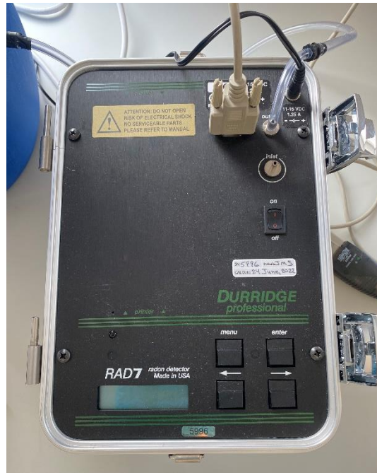
Figura 13. Detector activo RAD-7. (fuente: elaboración propia).
