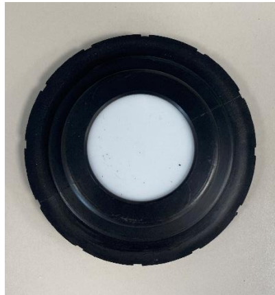
Figura 9. Disco de Teflón de un electrete. (fuente: elaboración propia).
