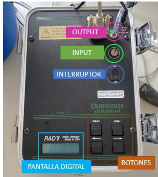
Figura 27. Elementos del equipo RAD-7. (fuente: elaboración propia).
