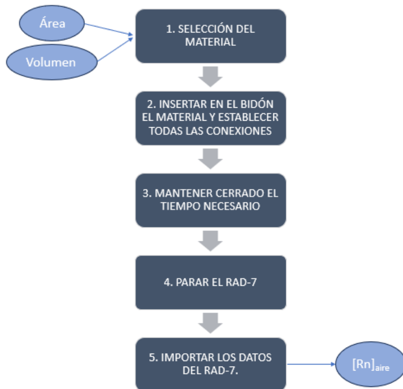
Figura 25. Diagrama de bloques del procedimiento de medición a partir del RAD-7.
