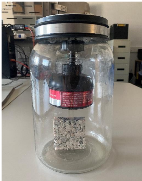
Figura 22. Jarra con la muestra a medir y el electrete y su cámara (fuente: elaboración propia)
