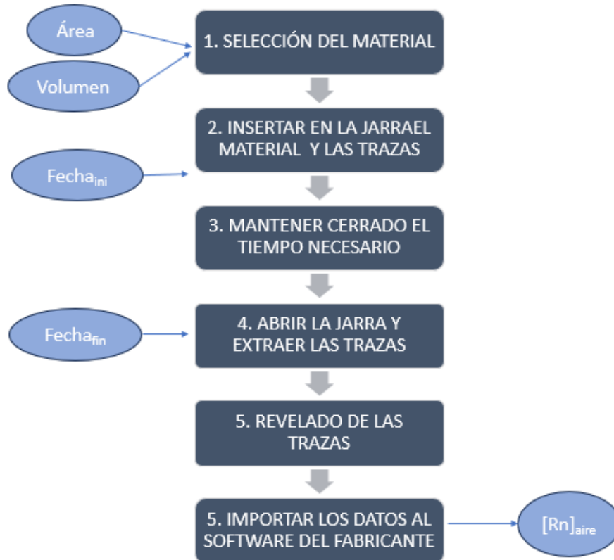
Figura 23. Diagrama de bloques del procedimiento de medición a partir de trazas.
