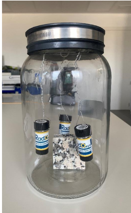
Figura 24. Jarra con el material de construcción y las trazas. (fuente: elaboración propia)
