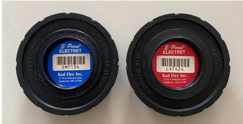
Figura 8. Electrete short-term (T) a la izquierda y long-term (LT) a la derecha. (fuente: elaboración propia).
