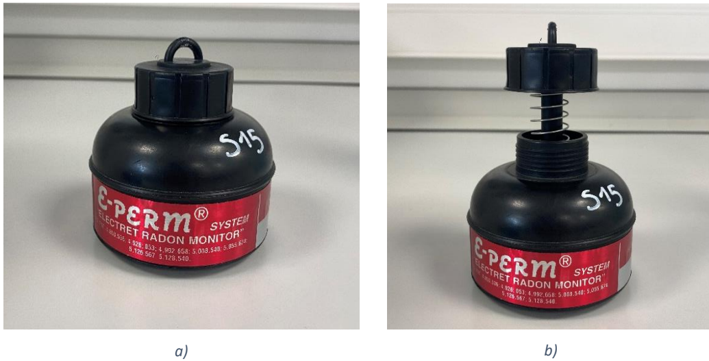
Figura 10. En la imagen a) se muestra una cámara S cerrada y en la imagen b) se muestra en posición abierta. (fuente: elaboración propia).
