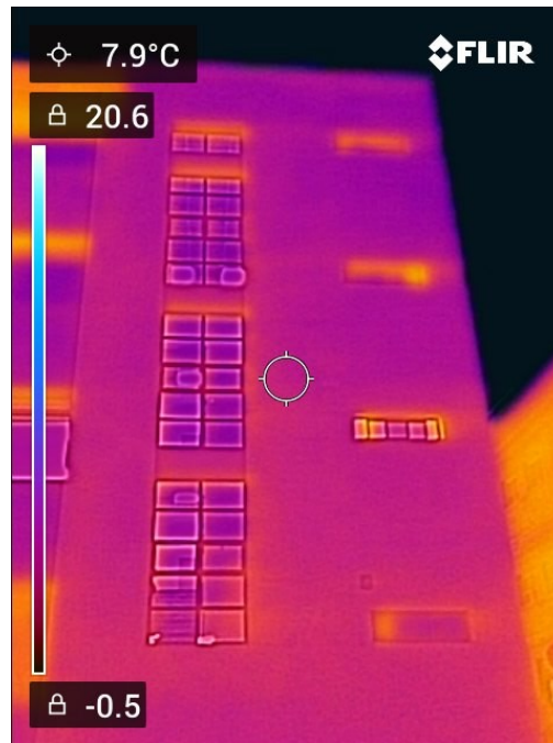
Figura 16. Puentes térmicos en el hueco de la escalera y aseos de fachada norte.
