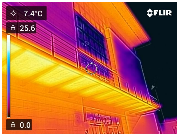
Figura 10. Puentes térmicos debido a escalera exterior en fachada sur.
