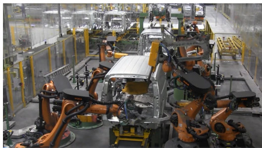
Figura 5.1: Línea de soldadura objeto de estudio, situada en la Factoría Ford de Almussafes (Valencia)
