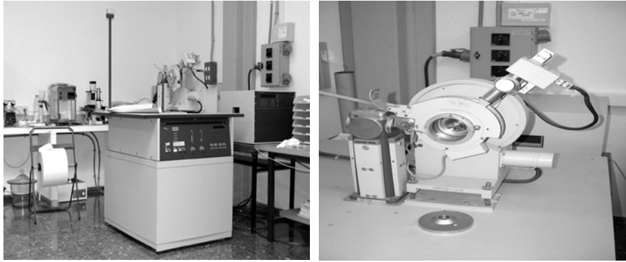
Figura 10. Philips PW1820, generador PW1830 y contador proporcional.
