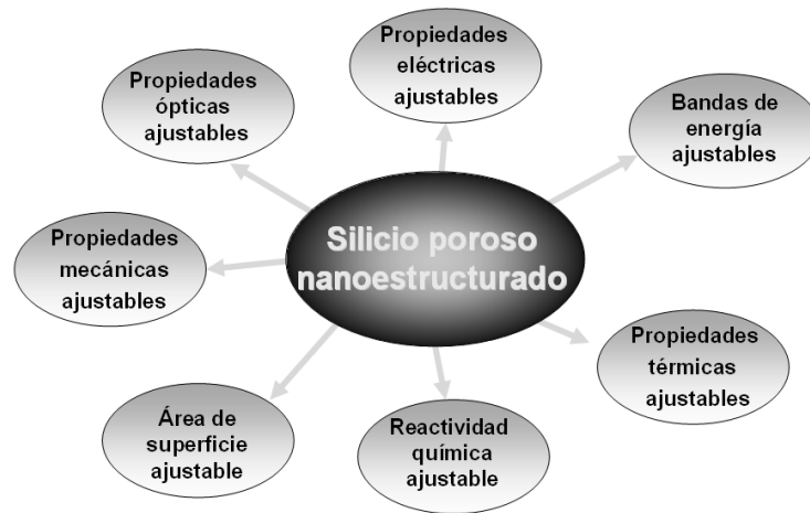
Figura 1. Propiedades regulables mediante la variación de las condiciones experimentales durante la formación de silicio poroso nanoestructurado.
