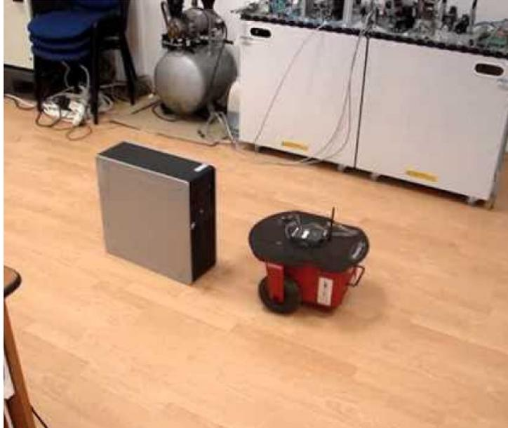
Figura 3.1: Pruebas de navegación en laboratorio con un Pioneer 2DX [30].
