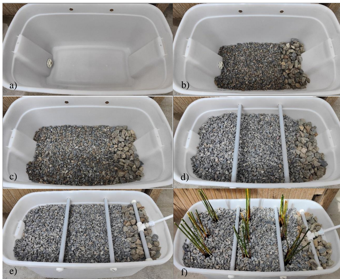
Figura 3.6. Vista del material de soporte, tubería distribución, salida y vegetación plantada en el HAFH, a) salida de fondo \frac{1}{2} ", b) fondo con capa de entrada y filtrante, c) parte intermedia capa de entrada y filtrante, d) sistema de refuerzo del recipiente, e) sistema de distribución de ingreso, f) vegetación plantada. Fuente: Fotografía tomada por el autor
