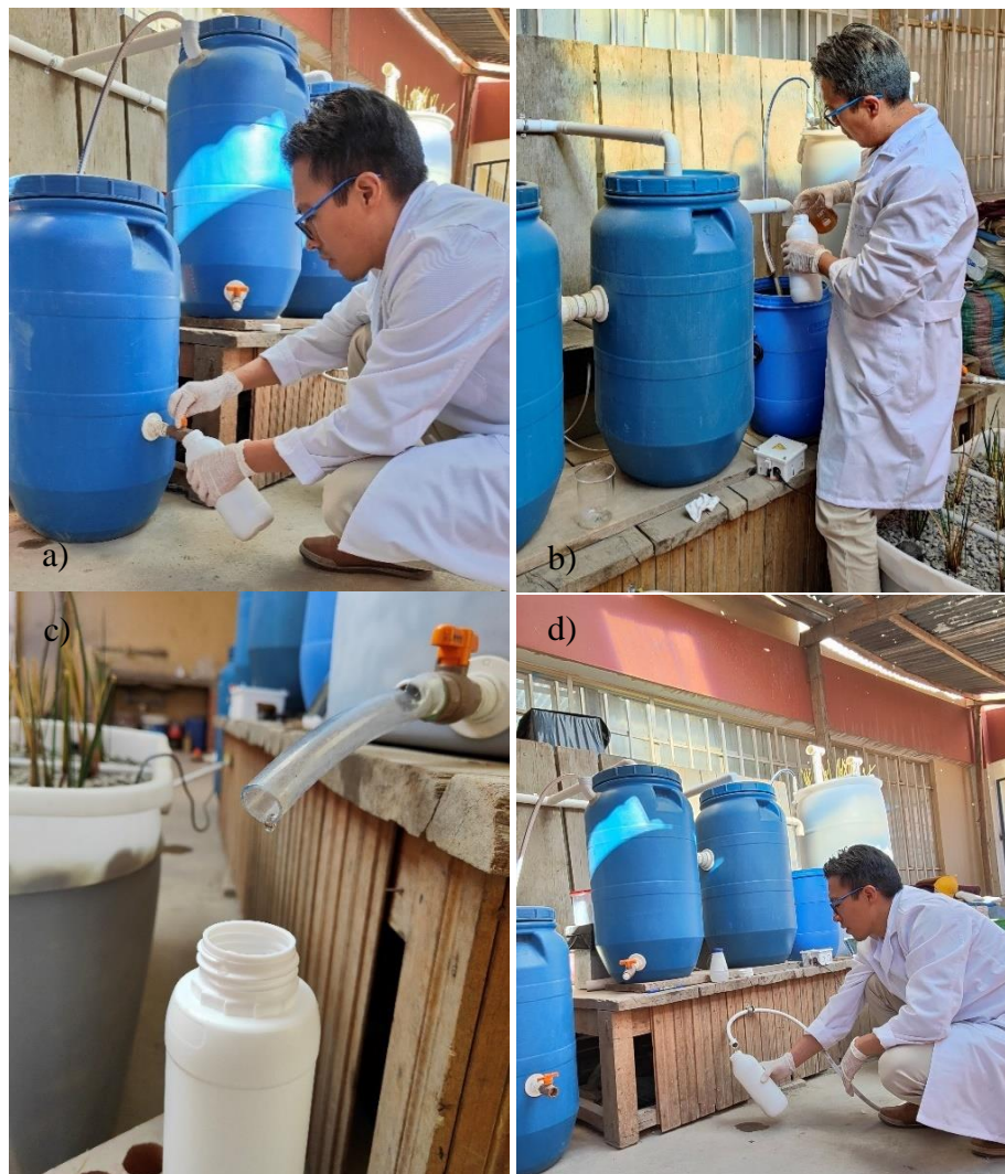
Figura 3.14. Toma de muestras de distintos puntos del sistema: a) M1. Tanque de alimentación, b) M2. Salida tanque séptico, c) M3. Salida HAFV y d) M4. Efluente tratado o salida HAFH. Fuente: Fotografía tomada por el autor
