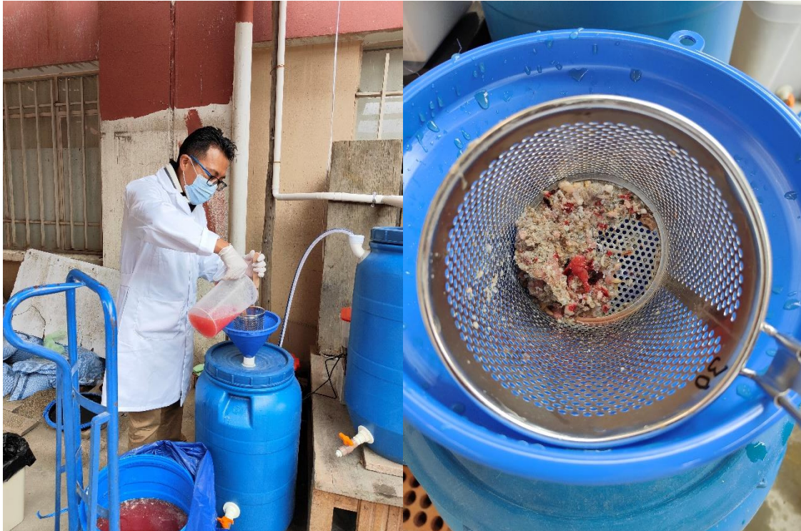
Figura 3.12. Alimentación del tanque de almacenamiento con aguas del matadero, a) llenado del tanque de almacenamiento, b) desbaste previo y recolección de las partículas de mayor tamaño. Fuente: Fotografía tomada por el autor
