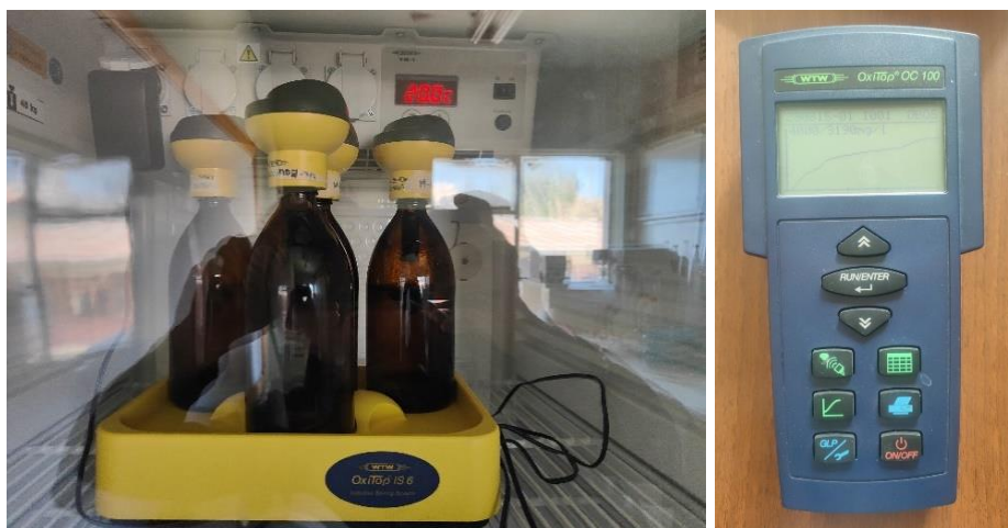
Figura 3.18. Equipo utilizado para la medición de la DBO 5 . Fuente: Fotografía tomada por el autor
