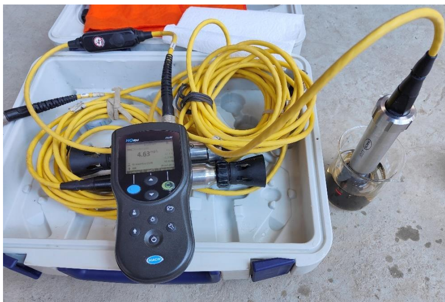
Figura 3.16. Medición de parámetros con sonda paramétrica Hach HQ40D. Fuente: Fotografía tomada por el autor
