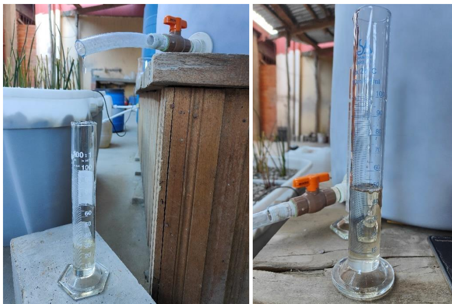
Figura 3.19. Medición de los volúmenes de descarga a la salida del HAFV. Fuente: Fotografía tomada por el autor
