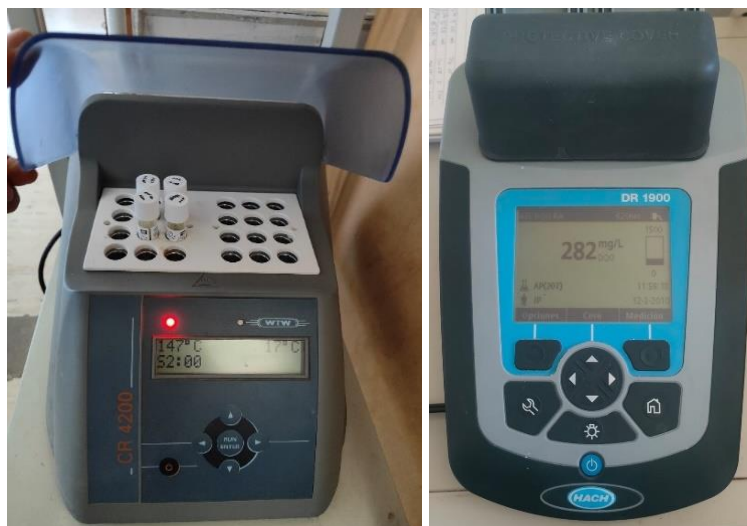
Figura 3.17. Termo reactor y espectrofotómetro utilizados para la determinación de la DQO. Fuente: Fotografía tomada por el autor
