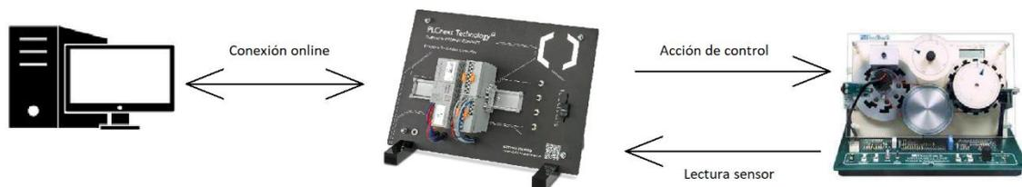
Figura 40. Esquema de comunicación en proceso experimental.
