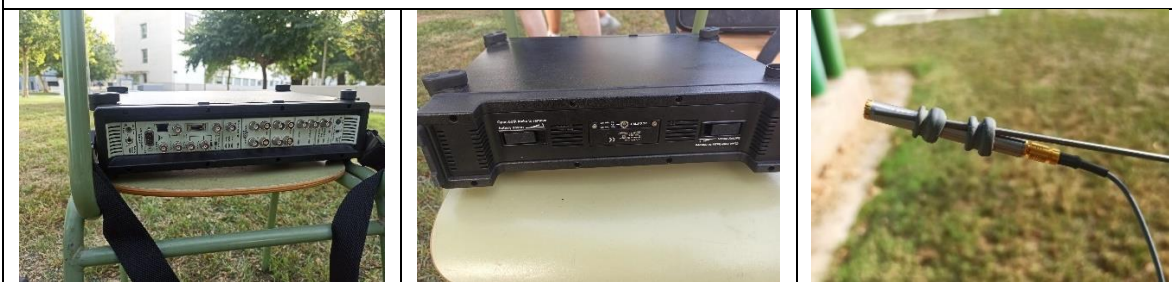
Equipos durante la medición, analizador de ruido Brüel & Kjaer PULSE 3560 (izquierda y centro) y micrófono tipo 4935 (derecha).
