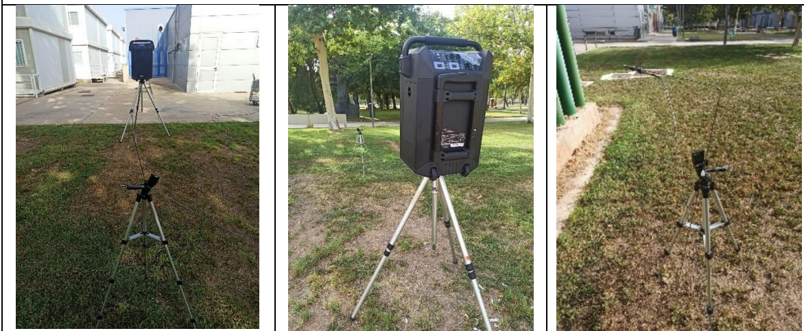
Equipos durante la medición (izquierda), altavoz Denon Audio Commander (centro) y micrófono tipo 4935 (derecha).
