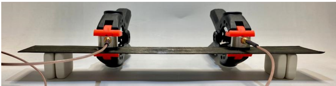
Figura 3.3: Sujeción de los sensores con pinzas de compresión.
