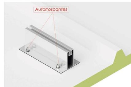
El perfil se fija a la chapa sandwich mediante 4 tornillos S42 (2 a cada lado).
