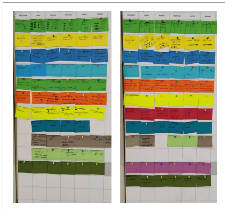
Figura 67. Ejemplo de paneles de planificación semanal Fotografía de obra
