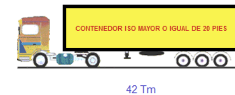
Figura 6. Carga máxima para camión de 2 ejes + semirremolque de 3 ejes. (Fuente: Ministerio de Transportes, 2023)
