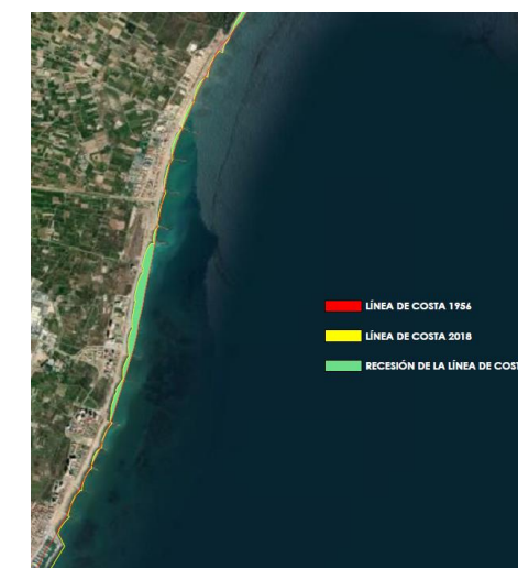
Figura 9. Evolución de la línea de costa entre 1956 y 2018. (Fuente: plano 2.2, 2023)
