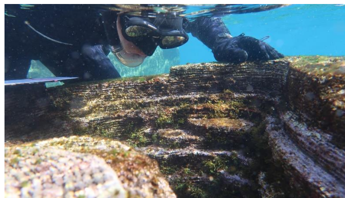
Figura 2. Imagen del uso de EConcrete en arrecifes artificiales. (Fuente: EConcrete, 2021).
