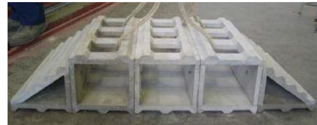
Figura 23. Configuración T3CT – Ancho de 12,5 metros. (Fuente: Medina, J.R. et.al, 2006)
