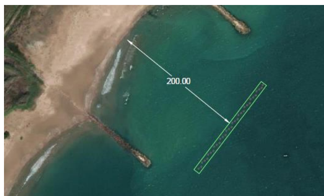
Figura 18. Distancia de colocación de las estructuras respecto la línea de costa. (Fuente: plano 7.8, 2023)
