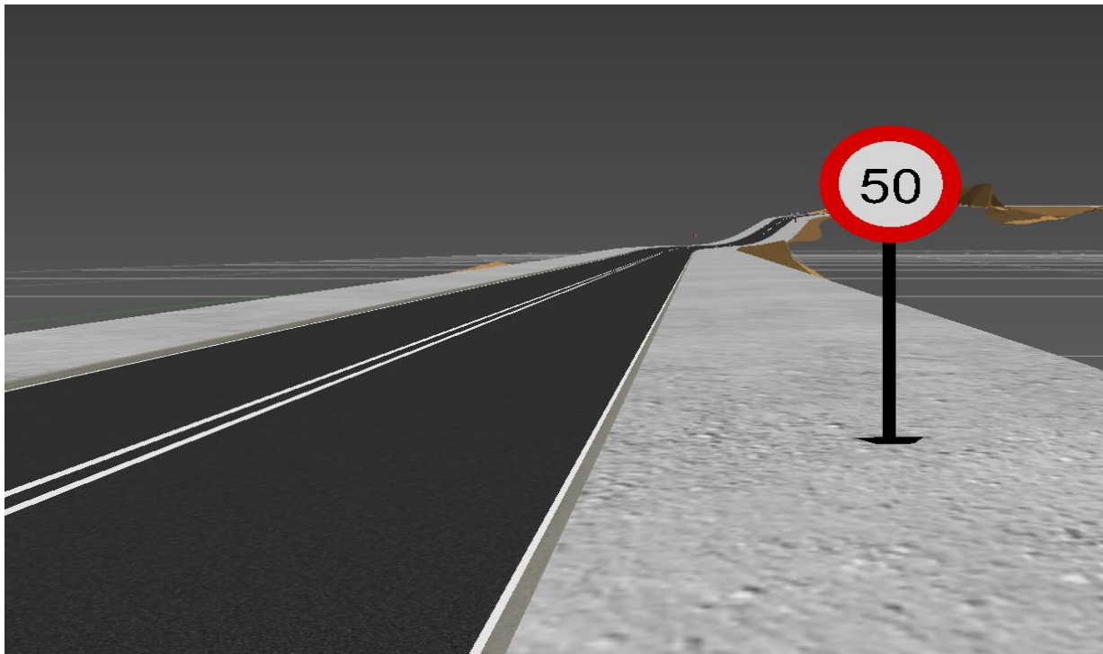
Figura 5-26 Esquema 3D de la señalización vertical SEÑAL R301
