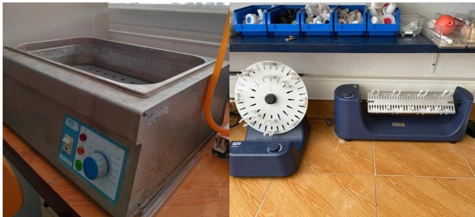
Figura 7. Máquina para el baño maría (derecha) y agitadores (izquierda).
