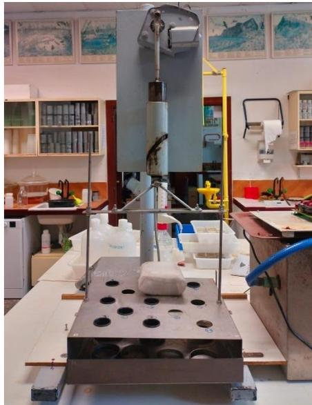
*Figura 9. Imagen del instrumento utilizado para tamizar las muestras de suelo en húmedo.*
