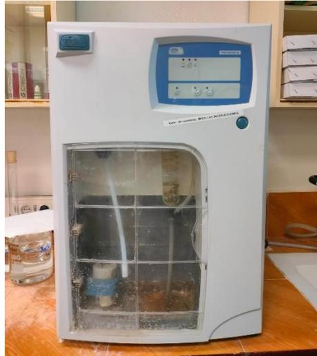
Figura 6. Imagen del instrumento utilizado para destilar las muestras.
