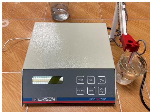
Figura 4. Conductímetro Crison micro-CM 2202 utilizado para medir la CE.
