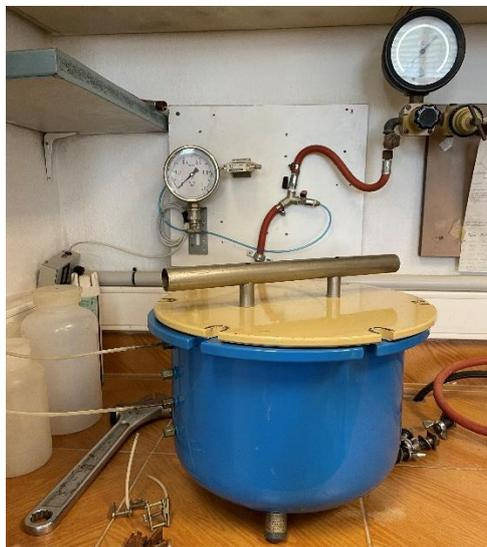
Figura 8. Olla a baja presión donde se deja drenar el agua libremente de las muestras de suelo.
