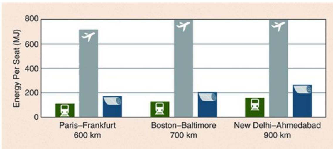
**Figura 2.1:** Consumo de energía por asiento en diferentes medios de transporte
