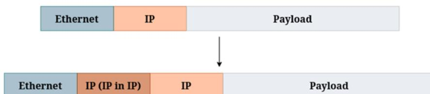
**Figura 3.3:** Encapsulación IP in IP
