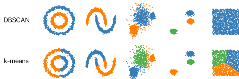
Figura 3 Resultados de kMeans y DBSCAN para distintos datos. Fuente: Towards Data Science.
