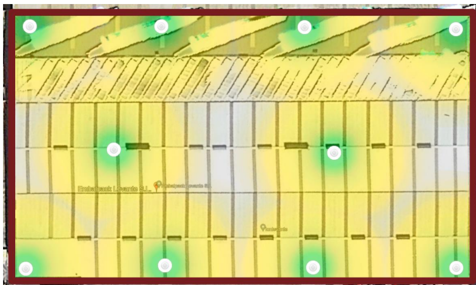
Ilustración 19: Diagrama beacons BLE para posicionamiento
