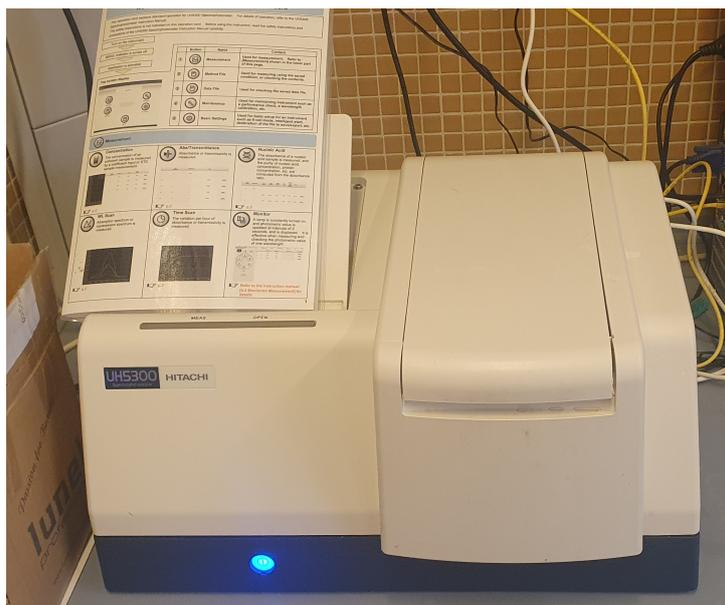
**Figura 3.7:** Espectrofotómetro UH5300 HITACHI.
