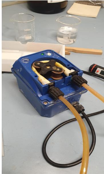
**Figura 3.9:** Bomba peristáltica SEKO PR7
