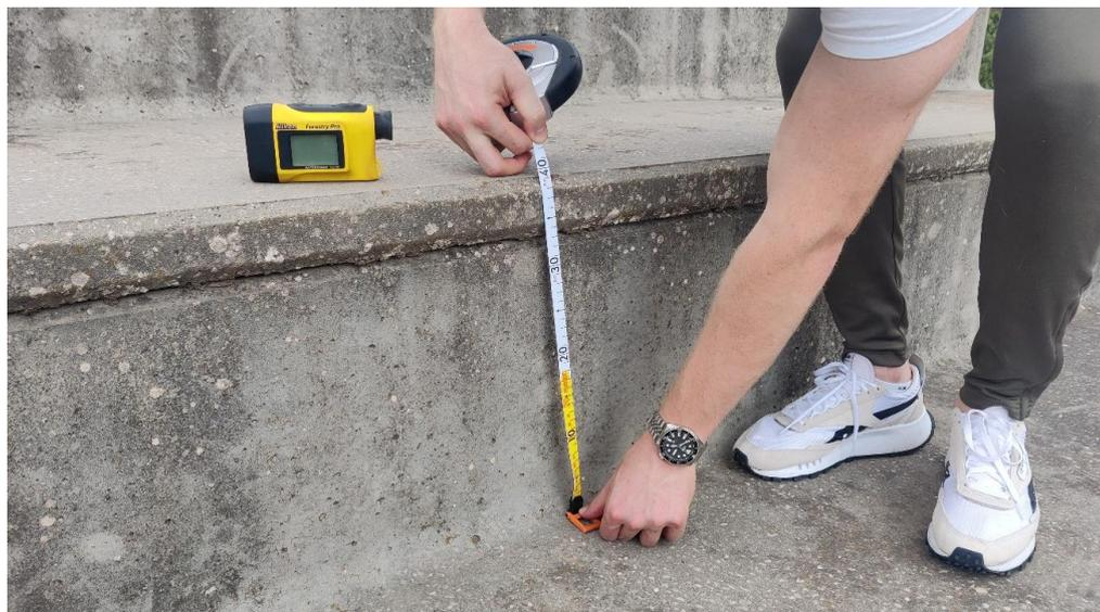
Figura 7. Medición altura escalón de grada.
