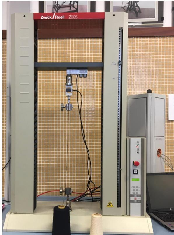
**Figura 37:** Foto del dinamómetro utilizado en los ensayos.
