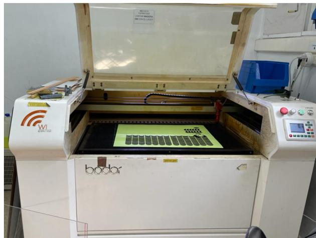
**Figura 34:** máquina láser utilizada para cortar las geometrías auxéticas sobre el material textil.
