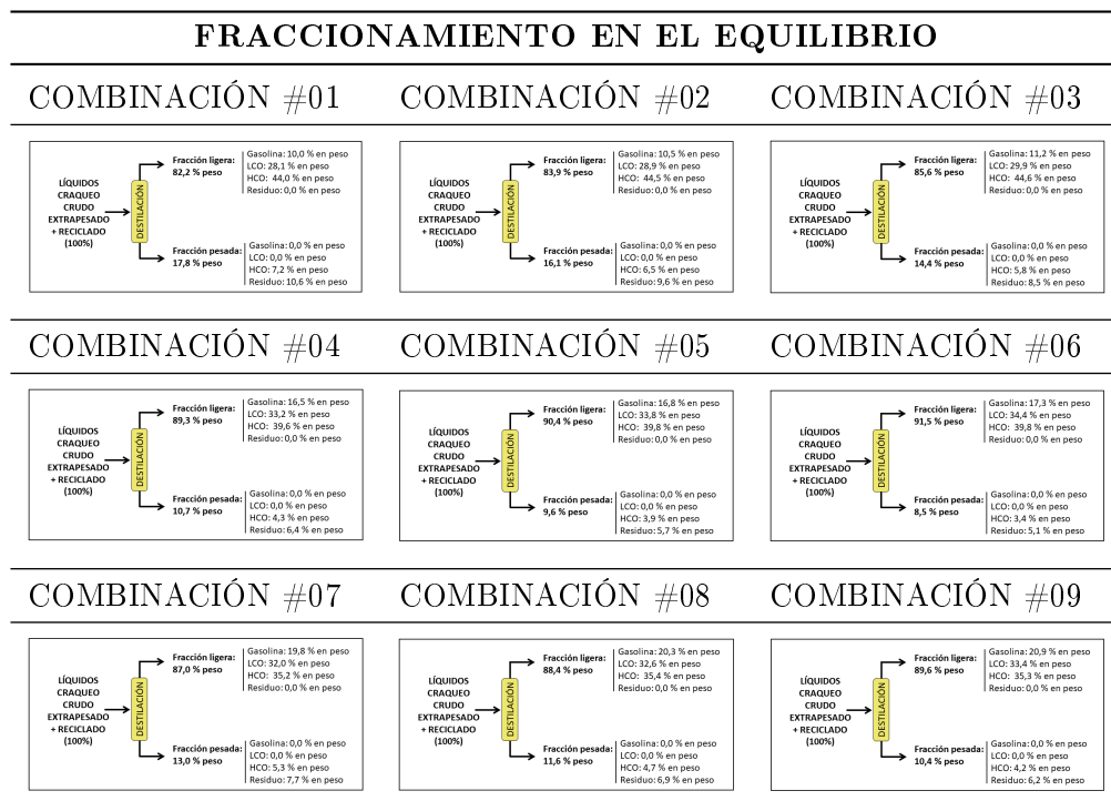
Figura 6.10: Balance de materia de las destilaciones cuando se alcanza el equilibrio en el proceso 2.
