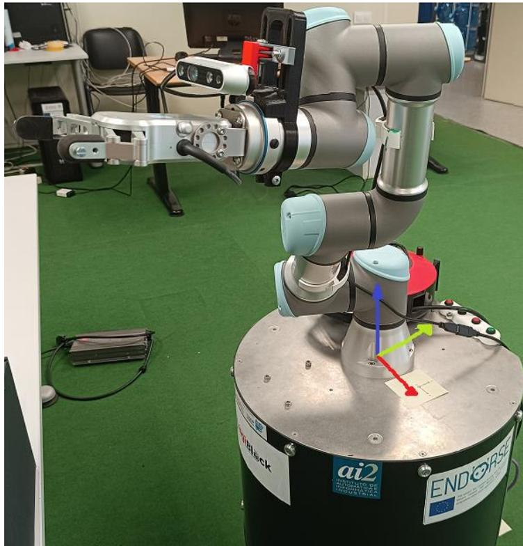
**Figura 21. Sistema de coordenadas del robot**
