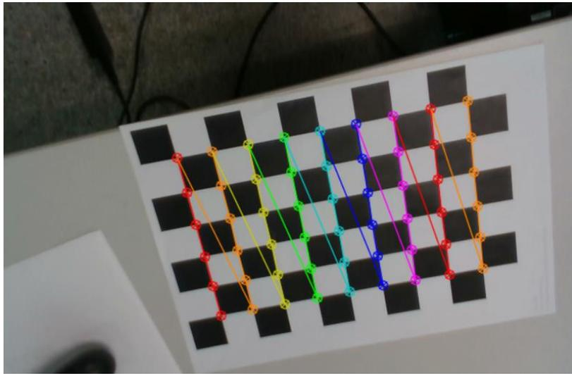
Figura 19. Imagen utilizada en la calibración de la cámara
