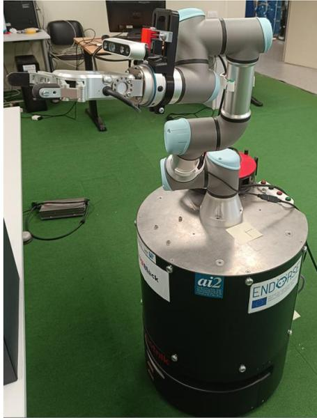
**Figura 1. Brazo robot acoplado en robot móvil**
