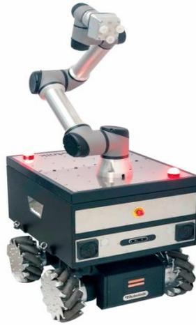
**Figura 7. Cobot instalado en un robot móvil**
