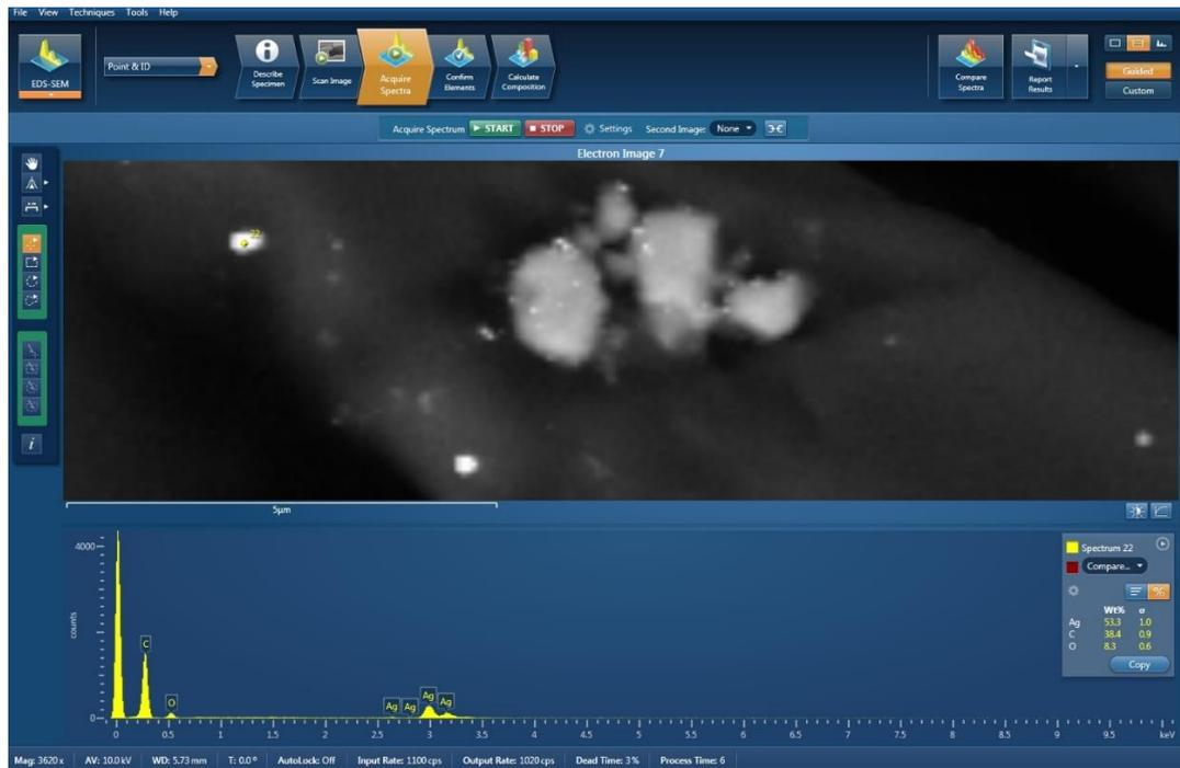
Figura 38. Ensayo EDS por punto de la muestra PLA-CPU-AG FyL.
