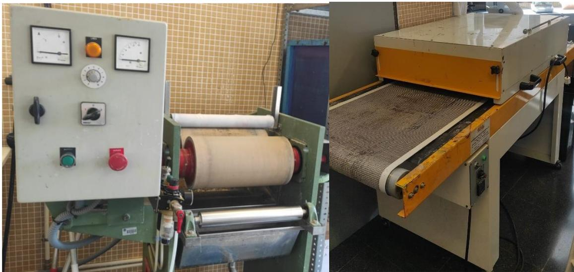
Figura 8. Foulard (*TEPA*) y secadero de rayos infrarrojos (TD-20, *S.P.E*).
