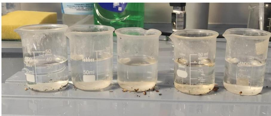
Figura 18. Vaso de precipitados con KOH que ha captado  $\text{CO}_2$ .
