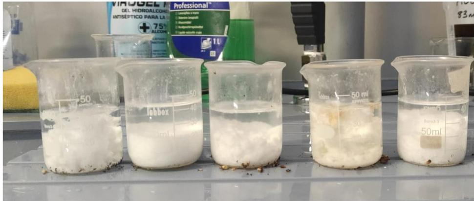
Figura 19. Vaso de precipitado de KOH con el CO<sub>2</sub> captado precipitado.
