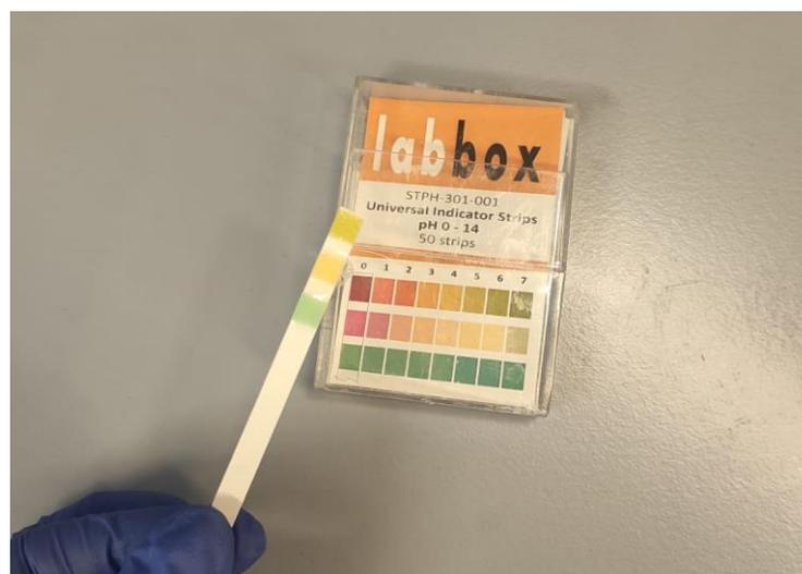
Figura 7. Medición pH del baño.
