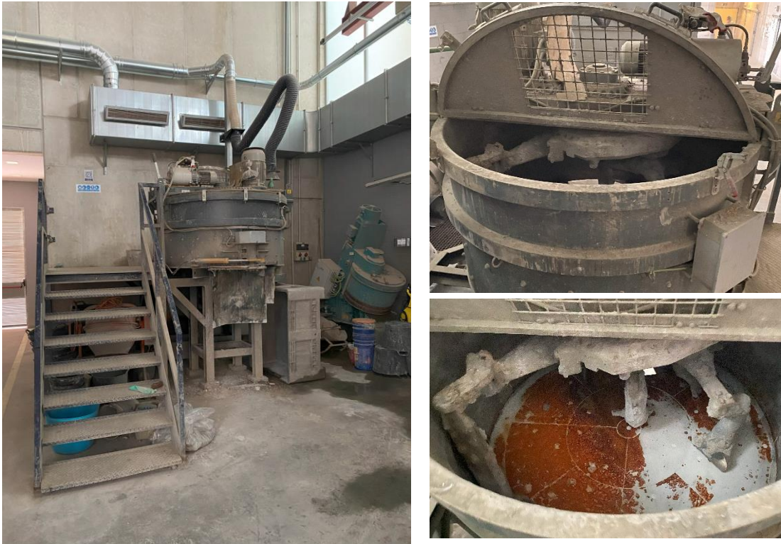
Figura. 70. Zona de amasado y amasadora utilizada para el amasado. (Fuente: Elaboración propia)
