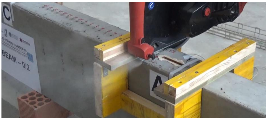
Figura. 58. Realización de un corte con sierra en la Viga 2a (Fuente: Imágenes cedidas por el proyecto PREPER).
