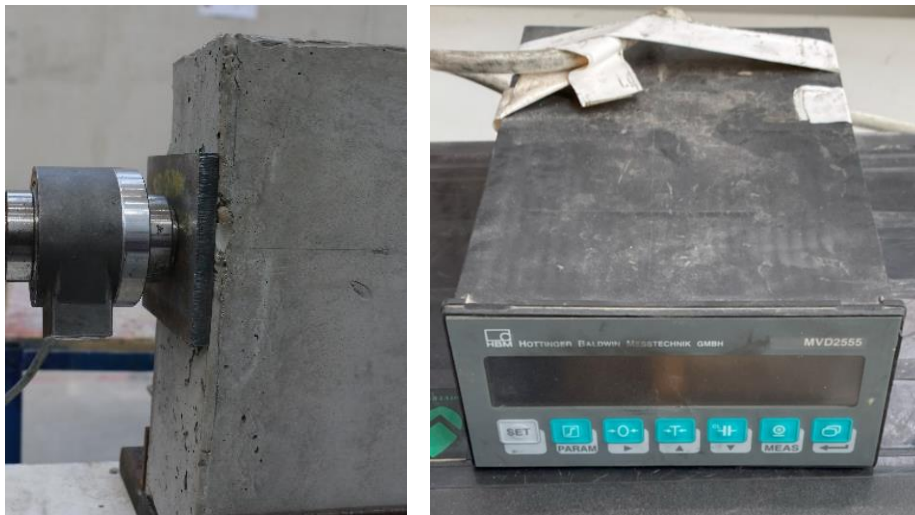
Figura. 80. Célula de carga (parte izquierda) y amplificador (parte derecha). (Fuente: Elaboración propia)
