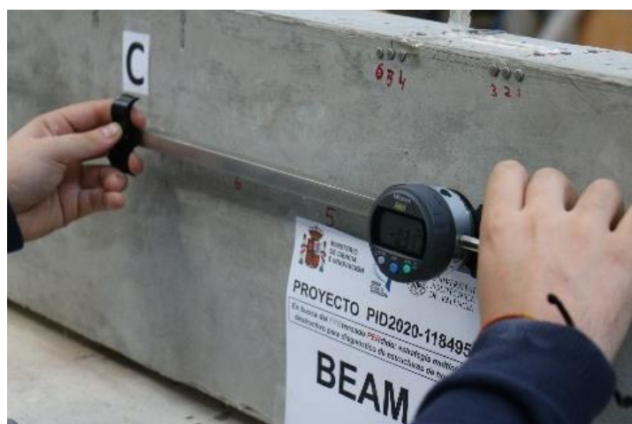
Figura. 89. Toma de mediciones de las deformaciones. (Fuente: imágenes cedidas por el proyecto PREPER)
