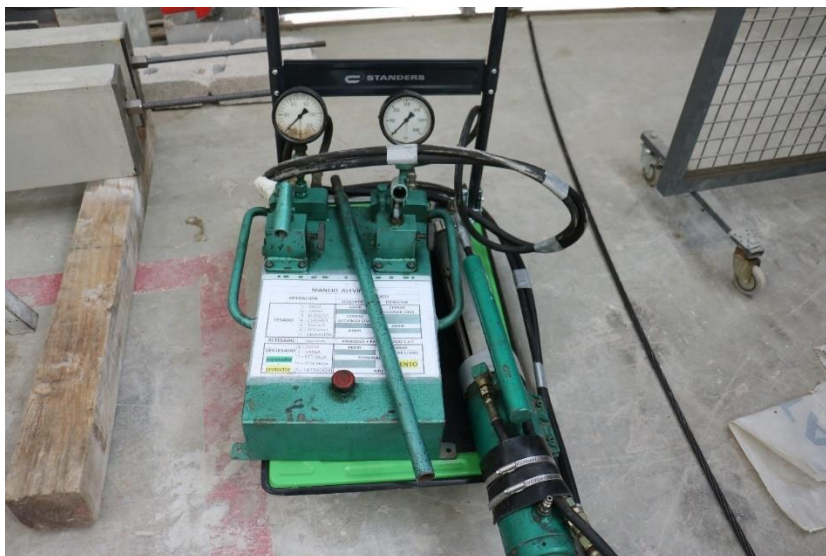
Figura. 79. Gato hidráulico tipo mono-strand. (Fuente: Elaboración propia)
