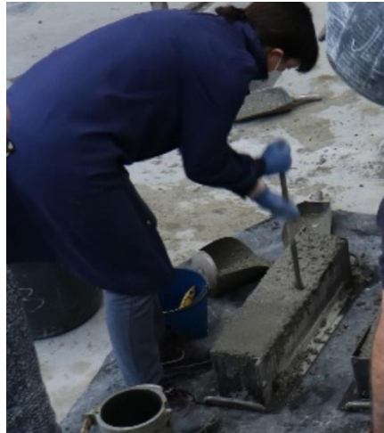
Figura. 74. Proceso de compactación de las probetas de flexotracción. (Fuente: Imágenes cedidas por el proyecto PREPER).
