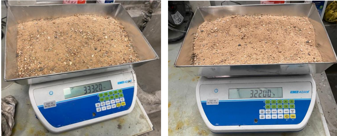
Figura. 69. Peso húmedo (Parte izquierda) y peso seco (Parte derecha) de la muestra de arena seleccionada. (Fuente: Elaboración propia).
