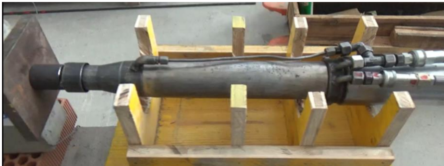
Figura. 60. Gato de cable único para un diámetro de cable de 15,2 mm. (Fuente: Imágenes cedidas por el proyecto PREPER).
