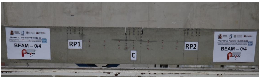
Figura. 93. Viga tras la finalización de la secuencia de cortes. (Fuente: Elaboración propia)
