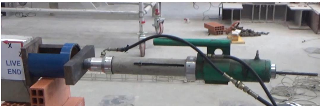
Figura. 56. Aplicación de un gato de un solo cable para alambre de 13 mm de diámetro (Fuente: Imágenes cedidas por el proyecto PREPER).
