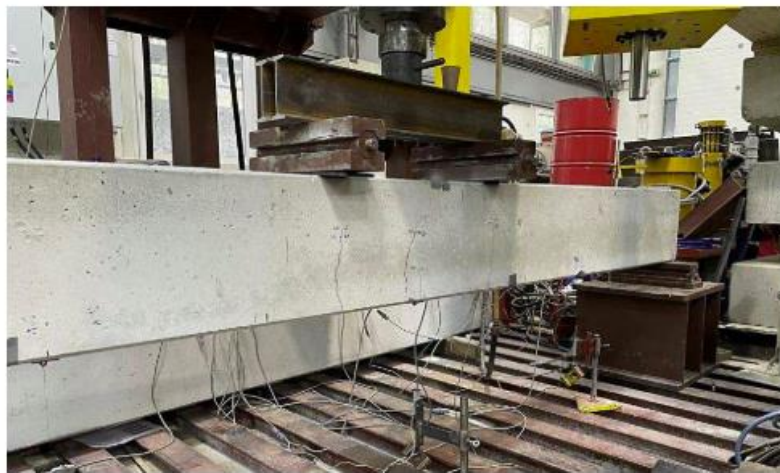
Figura. 49. Método de crack-opening en ejecución. (Fuente: Kralovanec & Moravčík, 2022)
