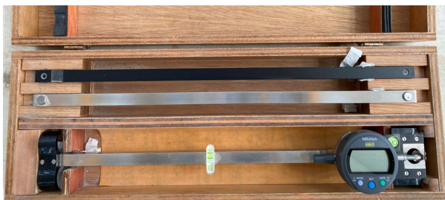
Figura. 82. DEMEC con base de medida 400 milímetros. (Fuente: Elaboración propia)
