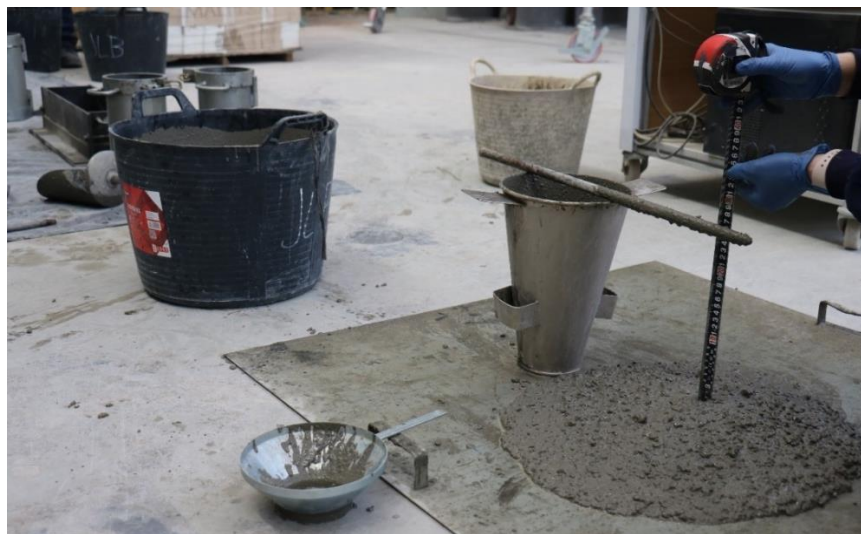
Figura. 75. Valor de consistencia obtenida en el cono de Abrams. (Fuente: Imágenes cedidas por el proyecto PREPER).
