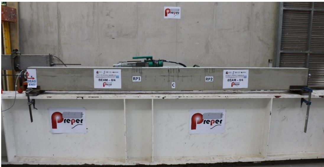
Figura. 92. Viga tras la finalización de la secuencia de cortes. (Fuente: Elaboración propia)
