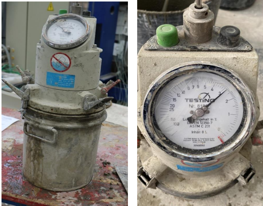
Figura. 76. Ensayo de permeabilidad y aire ocluido del hormigón. (Fuente: imágenes cedidas por el proyecto PREPER).
