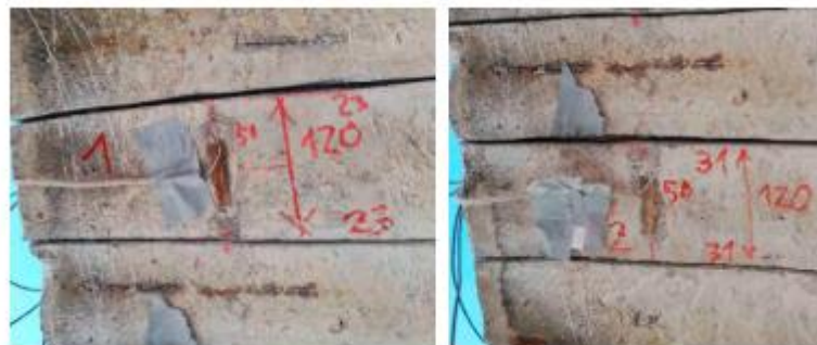
Figura. 29. Zonas de aplicación de la técnica del saw-cut. Plano en alzado de la sección a estudiar. (Fuente: Kralovanec, Moravčík, et al., 2021)
