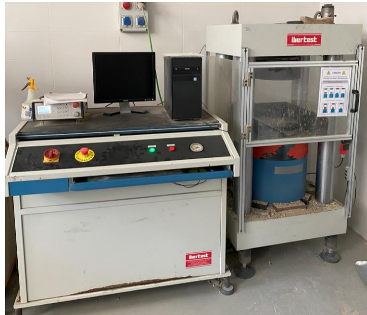
Figura. 78. Máquina IberTest utilizada para caracterizar el hormigón. (Fuente: Elaboración propia).
