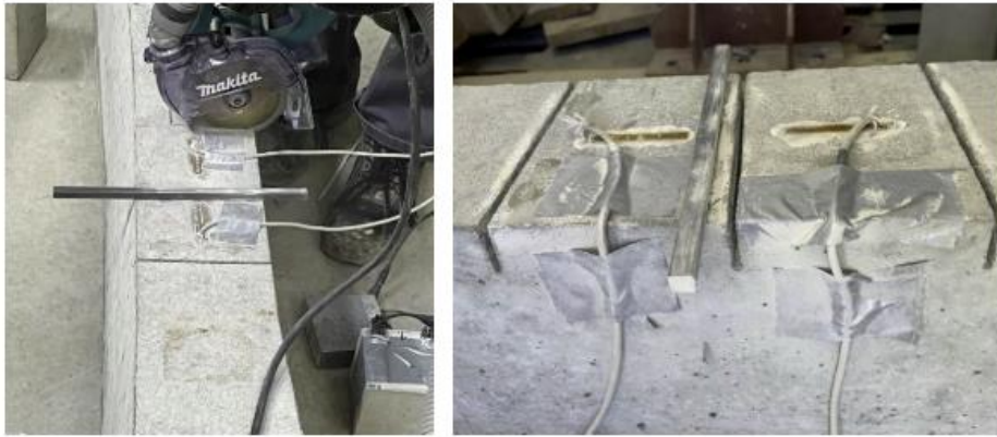
Figura. 38. Aplicación de la técnica del saw-cut al espécimen. (Fuente: Kralovanec et al., 2021)
