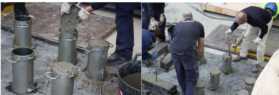
Figura. 73. Proceso de llenado y compactación de las probetas cilíndricas. (Fuente: Imágenes cedidas por el proyecto PREPER).
