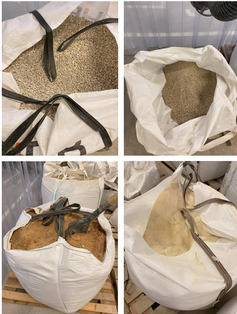
Figura. 64. Áridos empleados en la dosificación del hormigón. (Fuente: Elaboración Propia)
