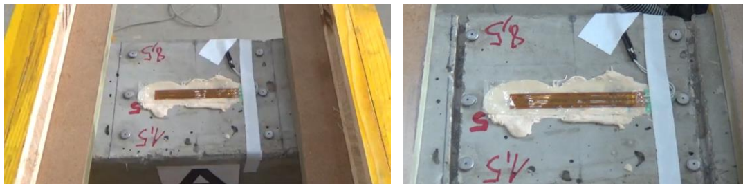
Figura. 59. Posicionamiento e instrumentación de un par de cortes, antes del corte (izquierda) y después del corte (derecha) (Fuente: Imágenes cedidas por el proyecto PREPER).
