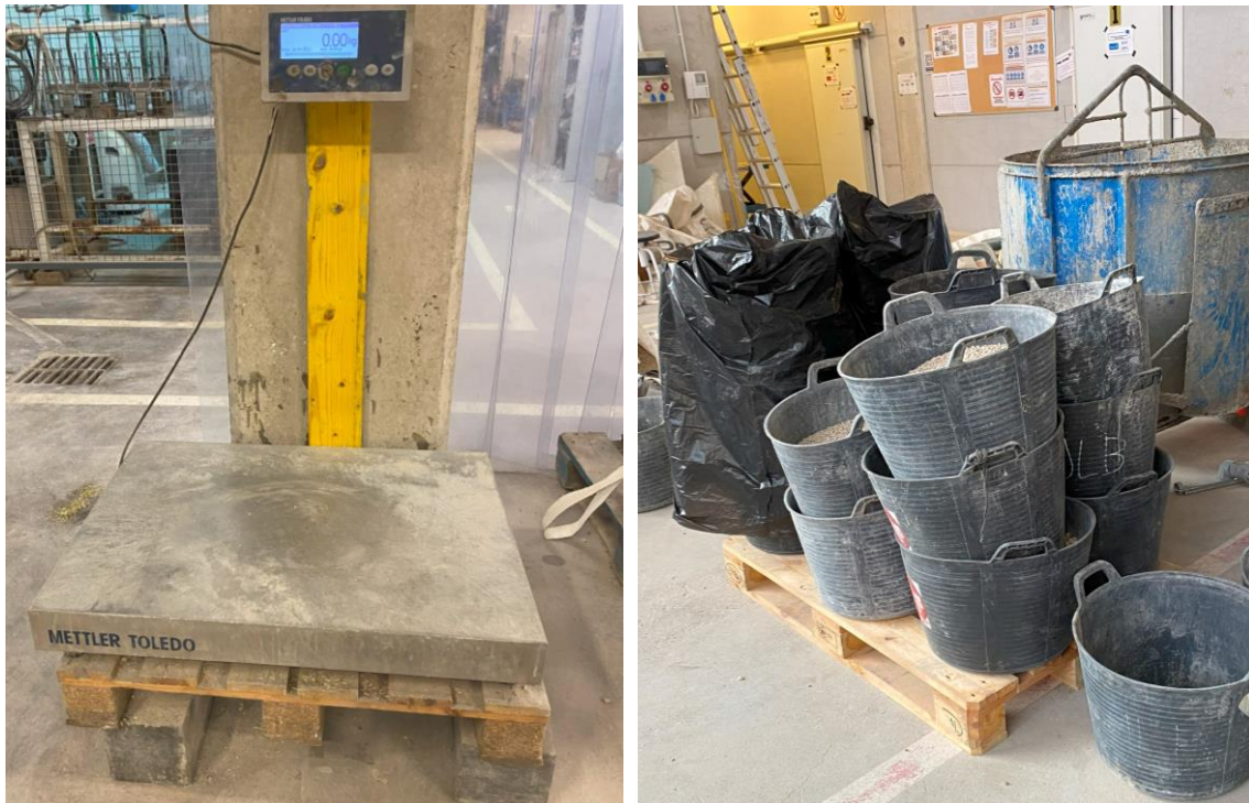
Figura. 67. Báscula de pesaje del material (Parte izquierda) y material pesado preparado para el vertido (Parte derecha) (Fuente: Elaboración propia)
