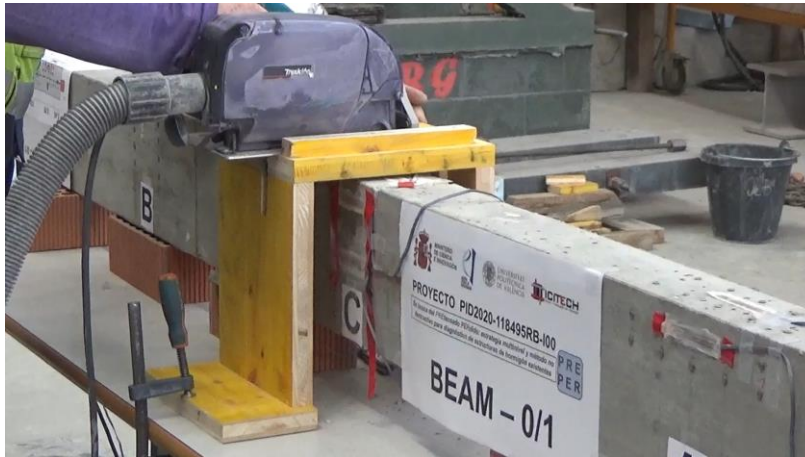
Figura. 55. Realización de un corte con sierra en la Viga 1 (Fuente: Imágenes cedidas por el proyecto PREPER).
