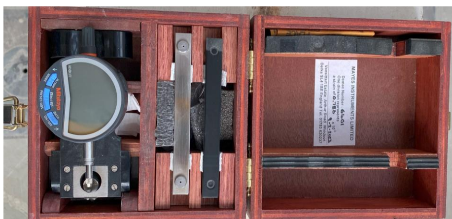
Figura. 81. DEMEC con base de medida 100 milímetros. (Fuente: Elaboración propia)
