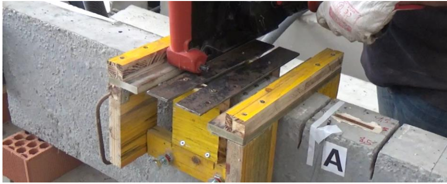
Figura. 61. Realización de un corte con sierra en la Viga 2b (Fuente: Imágenes cedidas por el proyecto PREPER).
