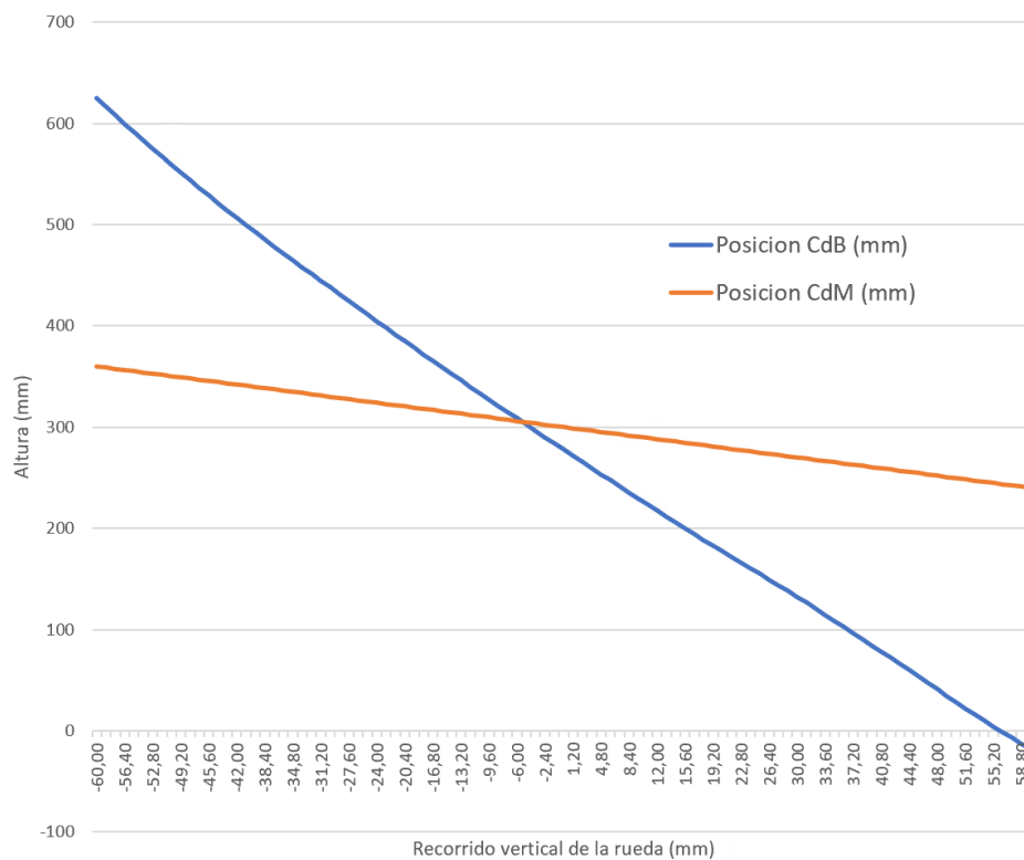
Figura 104: Localización del centro de balanceo y centro de masas del eje delantero con respecto al desplazamiento vertical de la rueda.
