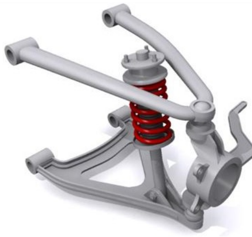
Figura 7: Sistema de suspensión de Doble Trapecio.
