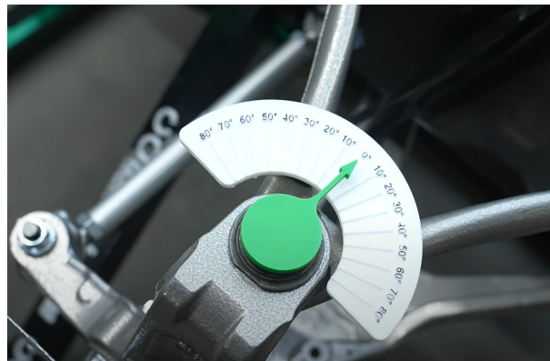
Figura 89: Sistema de medición de ángulos en el prototipo físico. Fuente: FDF Raceshop..
