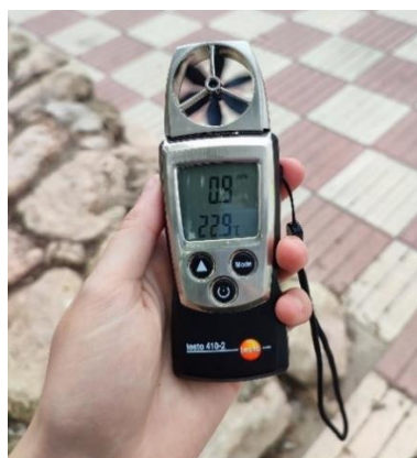
Ilustración 7. Anemómetro midiendo la temperatura y la velocidad del viento.
