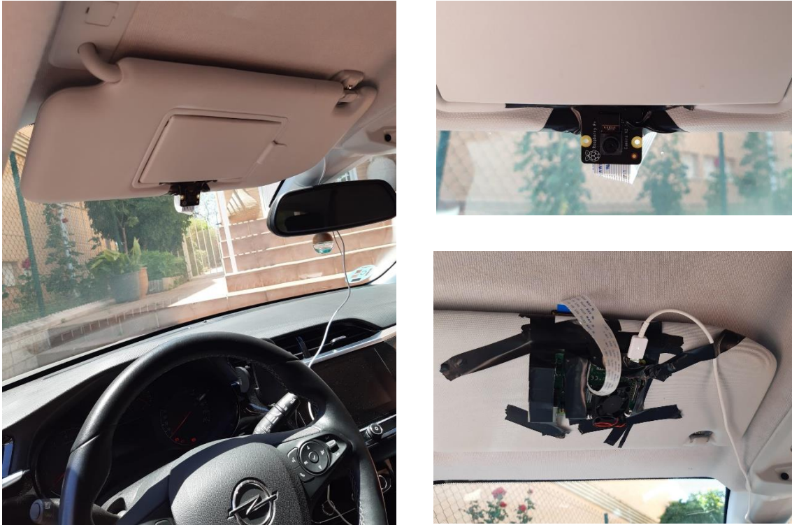
Figura 35. Montaje en vehículo del sistema de detección de somnolencia.
