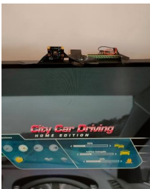
Figura 31. Posicionamiento de la cámara en el PC para los ensayos en simulación.
