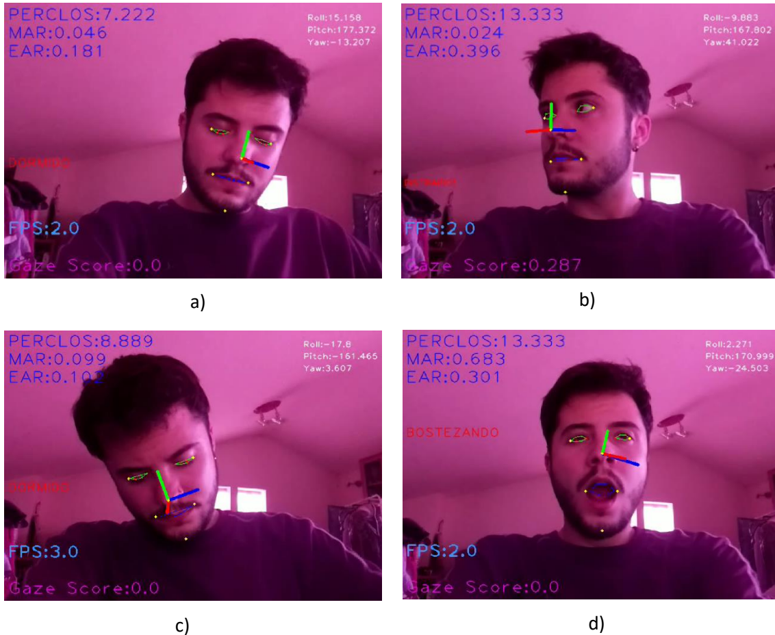
Figura 16. Ejemplos de prueba de funcionamiento del algoritmo con la Raspberry Pi y la NoIR Camera.
