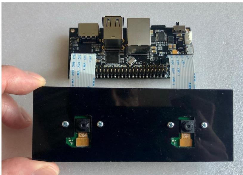
Figura. Montaje de las cámaras en estéreo
