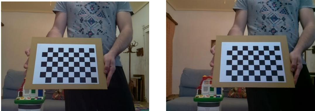
Figura. Imágenes de calibración separadas por cámaras izquierda y derecha
