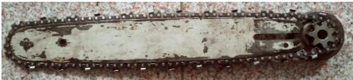
Figura 2. Cadena, fulla i engranatge d'una motoserra de combustió.
