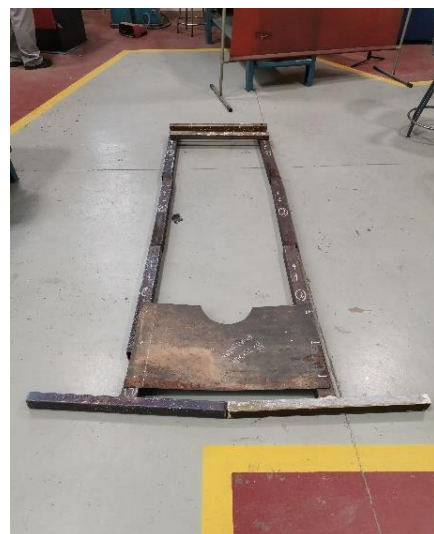
Fig. 36 Planteamiento de las piezas para su ensamblado.
