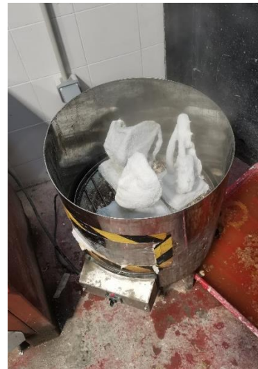
Fig. 30 Moldes en la licuadora para su descere.
