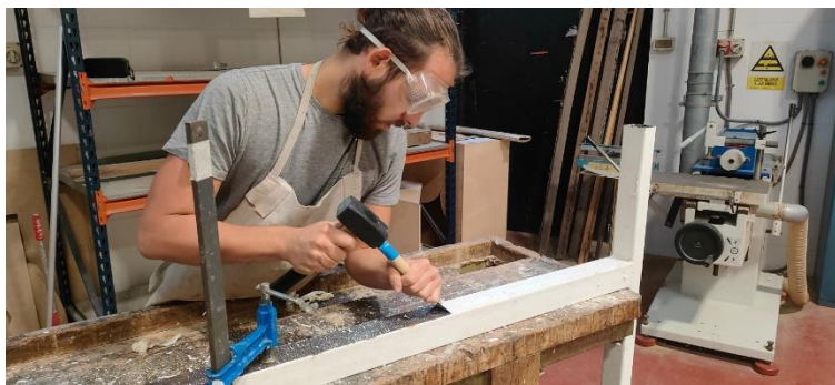
Fig. 35 Proceso de retiro de la pintura con martillo y espátula.
