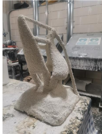
Fig. 29 Cascarilla cerámica con todos los baños aplicados, pero sin fibra de vidrio.
