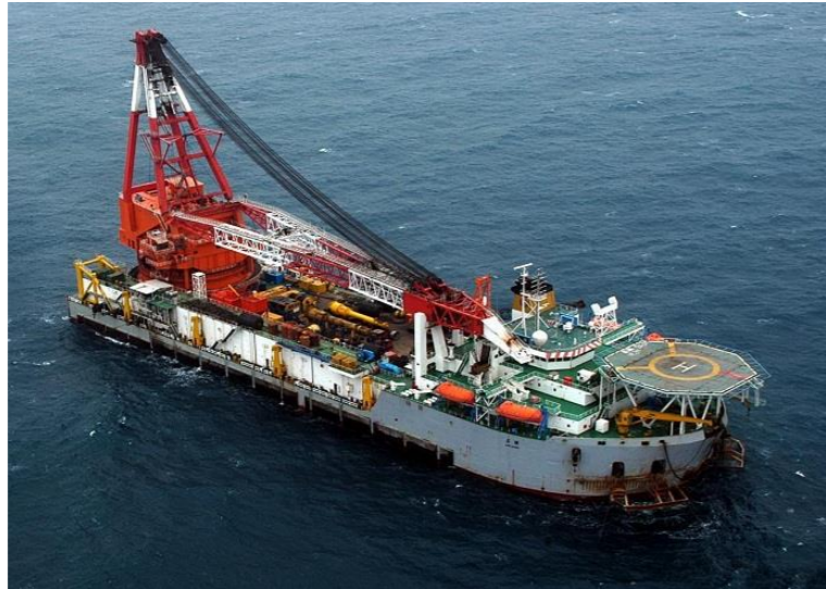
Figura 53. Barco grúa para la instalación de la plataforma y los brazos del WaveStar [44]
