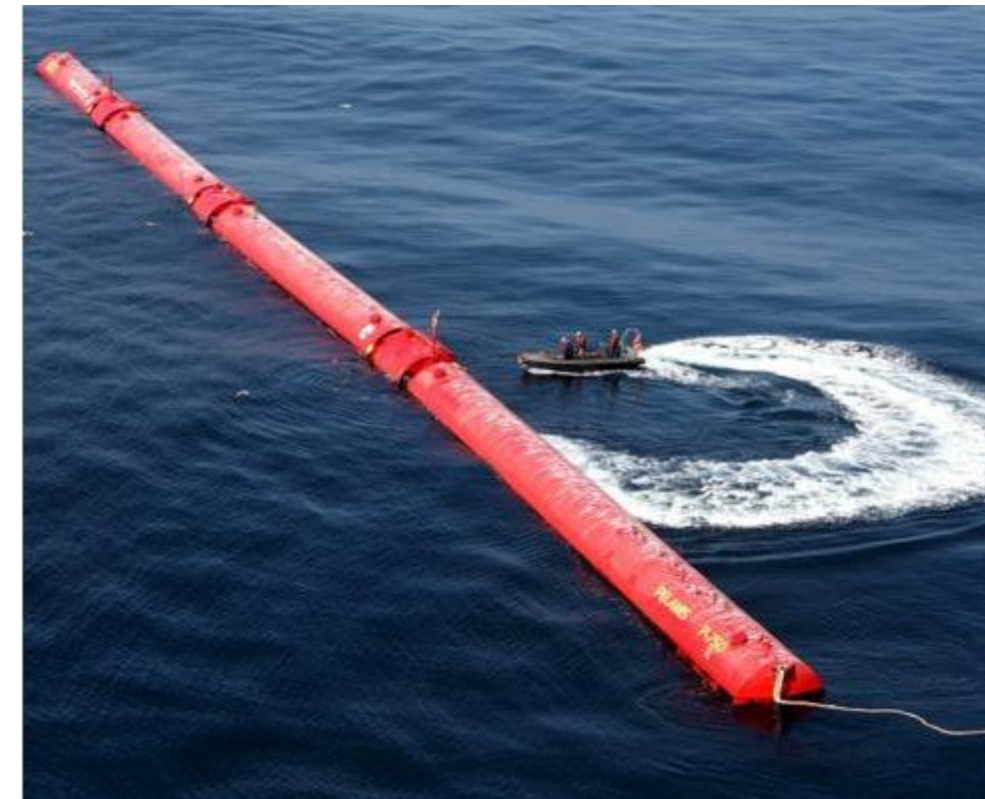
Figura 26. Dispositivo Pelamis de la central de energía undimotriz de Okeanos en Portugal [40]
