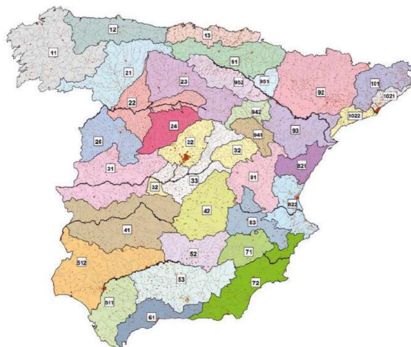
Imagen 11: Regiones consideradas para determinación del coeficiente corrector del umbral de escorrentía. Fuente: Norma 5.2 I.C Instrucciones de Carreteras
