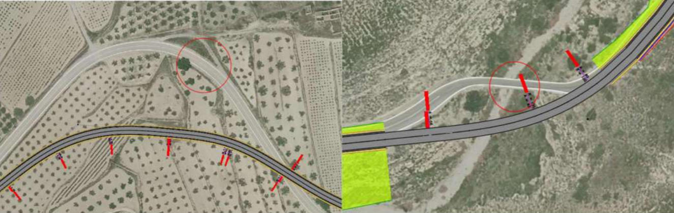
Imagen 14: Obras de drenaje transversal situadas en los P.Ks 4+265 y 6+560 Fuente: Elaboración propia
