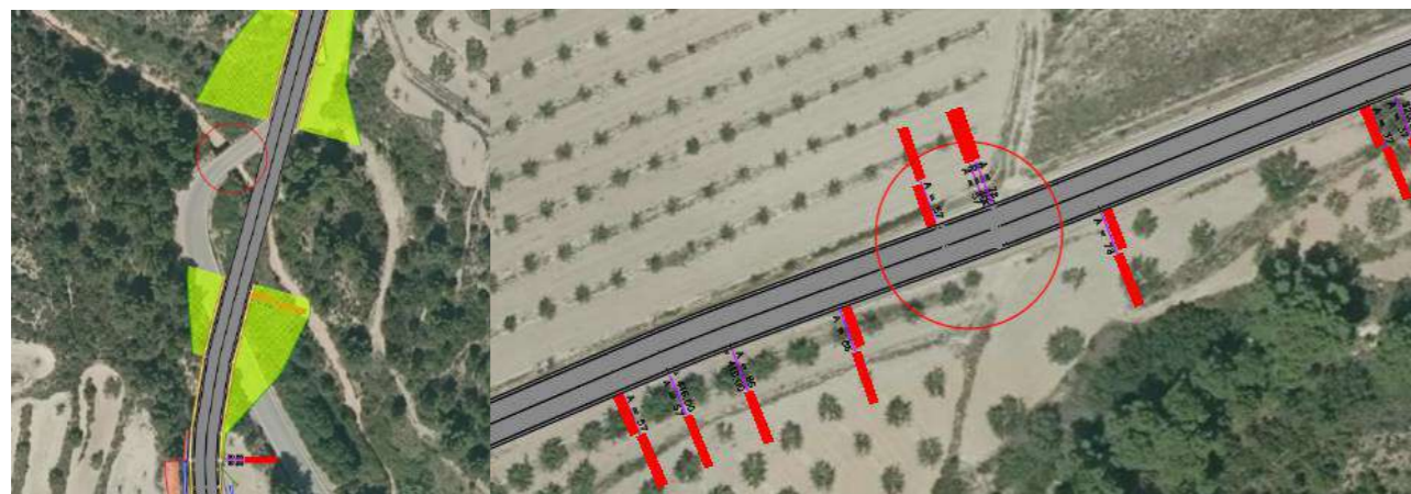
Imagen 13: Obras de drenaje transversal situadas en los P.Ks 1+220 y 2+445 Fuente: Elaboración propia
