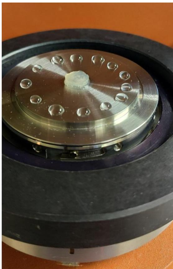
Figura 11. Scaffold colocado en el plato inferior del reómetro. Alrededor, las gotas de agua y parte del sistema *Solvent trap* (negro).
