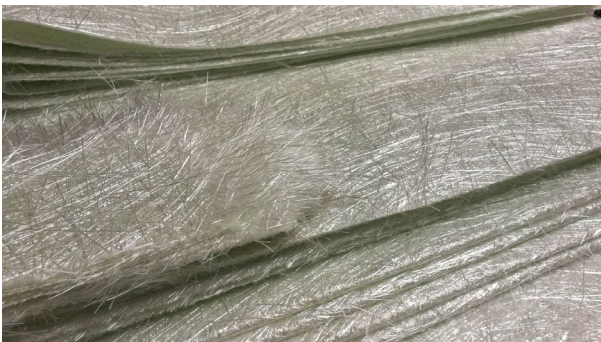
Figura 96. Detalle del aspecto de la fibra de vidrio. Fuente Aislamientos Carranza
