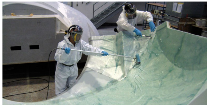
Figura 97. Moldeo manual de una pieza en fibra de vidrio y resina. Fuente Blog Tecnología de los plásticos
