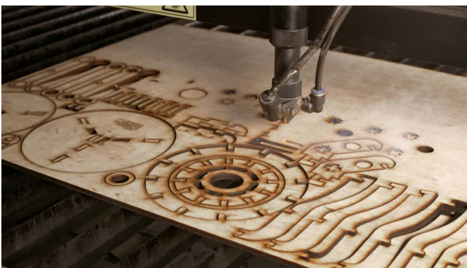
Figura 116. Máquina de corte láser cortando piezas de madera. Fuente Colorprinter
