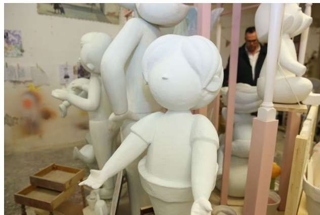
Figura 93. Ninots recubiertos de gotelé, esperando a ser lijados, en el taller de Cap de Suro. Fuente Josep V. Zaragoza
