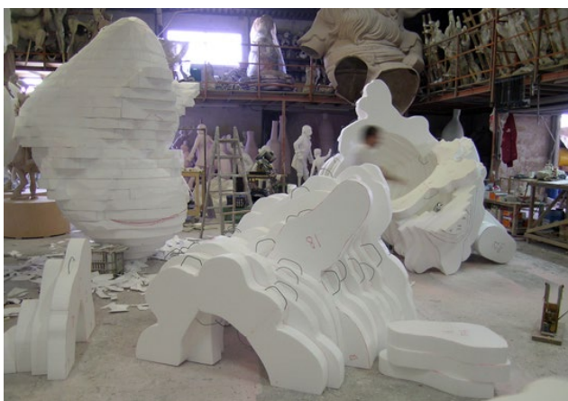
Figura 105. Proceso de unión de los perfiles de poliestireno para la creación de un remate. Fuente Universitat de València
