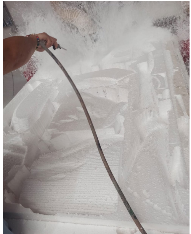
Figura 183. Limpieza y eliminación de los residuos de las placas fresadas. Fuente Ana Duro
