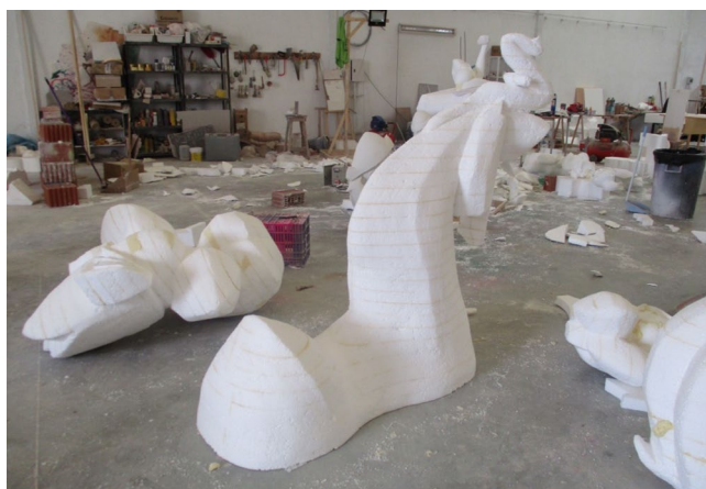
Figura 106. Figuras de poliestireno ya modeladas, donde se observan las distintas placas utilizadas para la obtención del ninot. Fuente Elaboración propia
