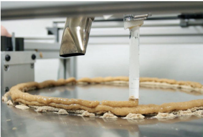
Figura 136. Prototipo de impresora para el nuevo material realizado por Mat in Mat, donde se observa la aplicación de calor sobre el material. Fuente Mat in Mat
