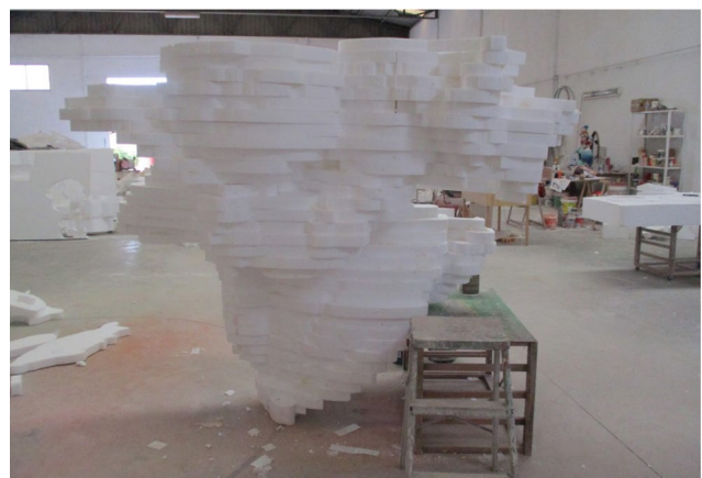
Figura 16. Obtención de una figura de poliestireno expandido por la superposición de planchas cortadas por CNC. Fuente Elaboración Propia
