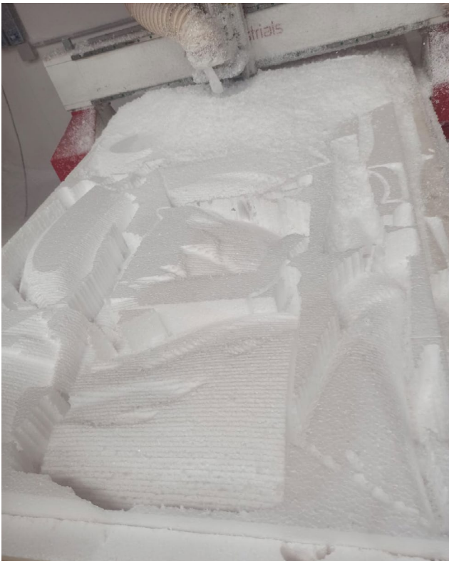
Figura 182. Fresadora realizando el mecanizado de las piezas. Fuente Ana Duro
