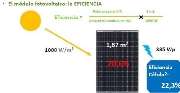
Figura 8. Cálculo de la eficiencia de un módulo fotovoltaico.
