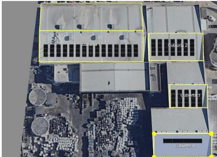
Figura 28. Distribución final de los paneles.
