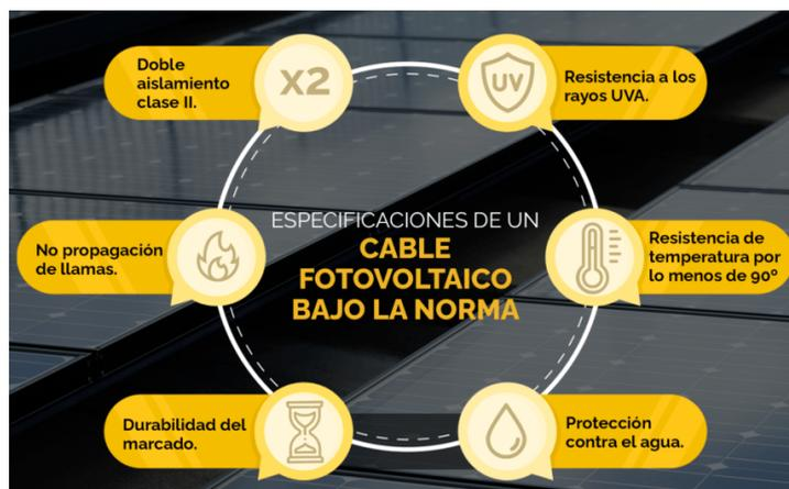
Figura 36. Especificaciones de un cable destinado a energía fotovoltaica.
