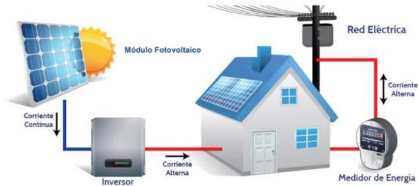
Figura 14. Esquema simplificado de un sistema solar conectado a la red.
