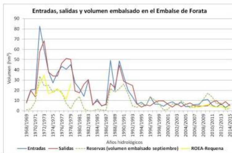
Figura 11: Embalse de Forata-salidas, volumen embalsado y estación de aforos de la ROEA Río Magro en Requena.
