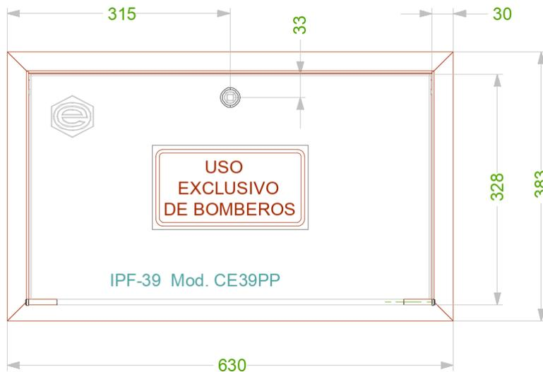
**Ilustración 22. Esquema de la caja de las bocas de columna seca**
