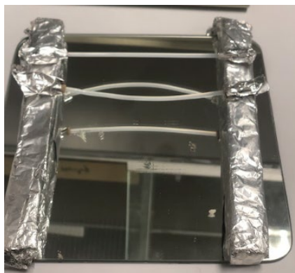
Figura 16. Columna rellena con disolución de ataque de la pared interna sobre el espejo (A) y en el interior de la cámara de UV (B).
