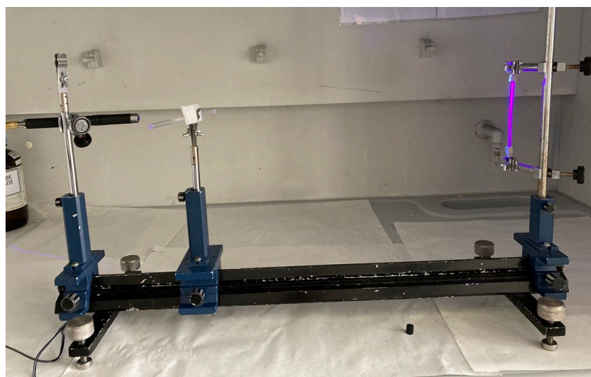
Figura 19. Montaje para la irradiación de la columna con láser abierto.
