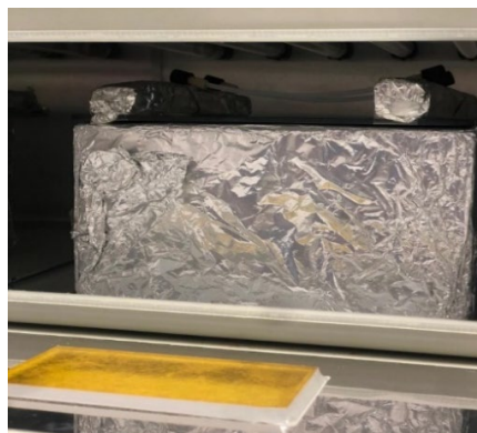
Figura 16. Columna rellena con disolución de ataque de la pared interna sobre el espejo (A) y en el interior de la cámara de UV (B).
