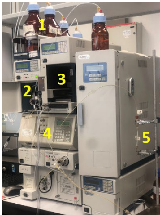
Figura 26. Sistema de HPLC de la UPV. 1. Recipientes con la fase móvil. 2. Bomba de alta presión. 3. Inyector automático. 4. Detector de fluorescencia. 5. Columna.
