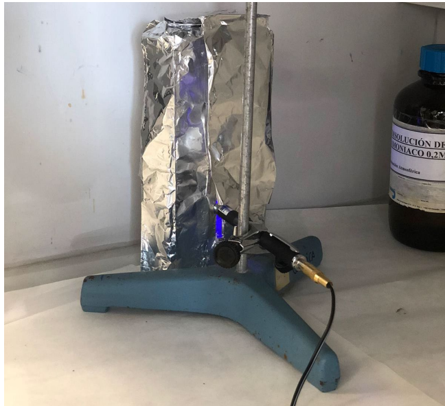
Figura 18. Montaje para la irradiación puntual de la columna.
