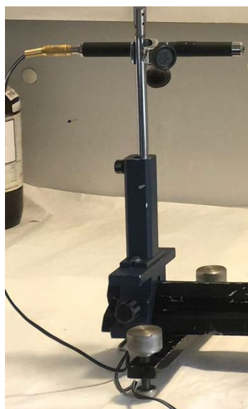
Figura 17. Puntero láser azul modificado para conectarlo a la corriente eléctrica.
