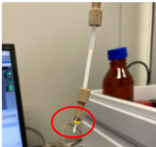
Figura 29. Lavado en el sistema HPLC de la Columna 1. En el círculo, se observa la columna saliéndose.
