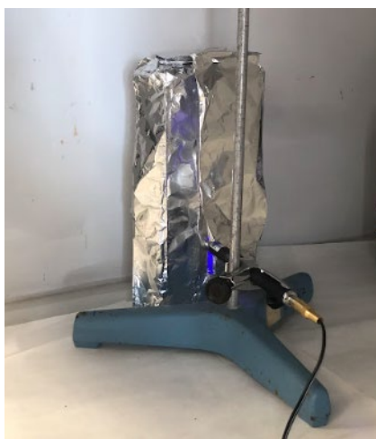
Figura 32. Montaje para la polimerización vertical (columna 7) con la columna abierta por el extremo superior.
